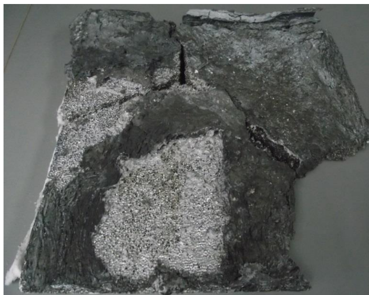
Figura 3.16 Filtrul pe bază de Al_2O_3 după filtrare
