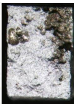
Figura 3.48. Exemplu de defecte prezente în aliajul HPDC
