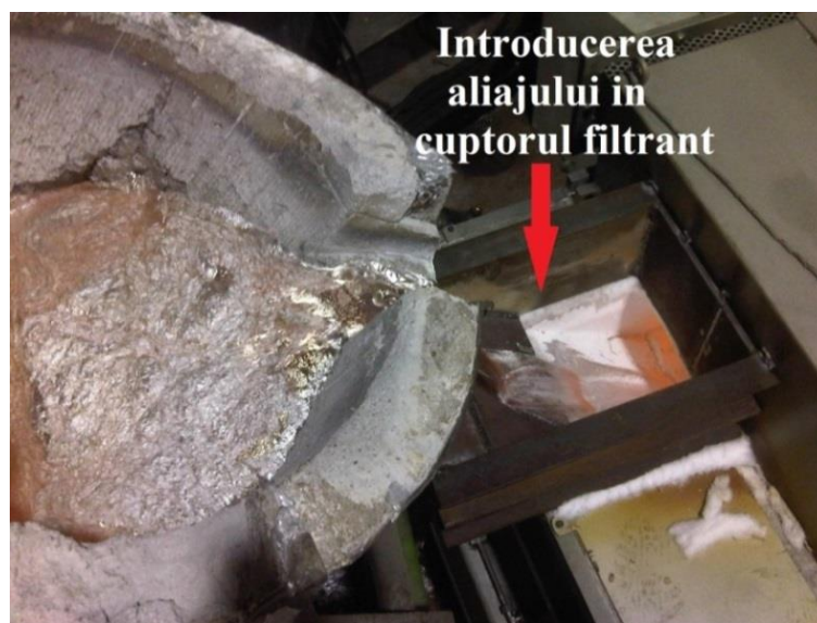
Figura 3.13. Zona prin care se introduce aliajul în Cuptorul filtrant Krown
