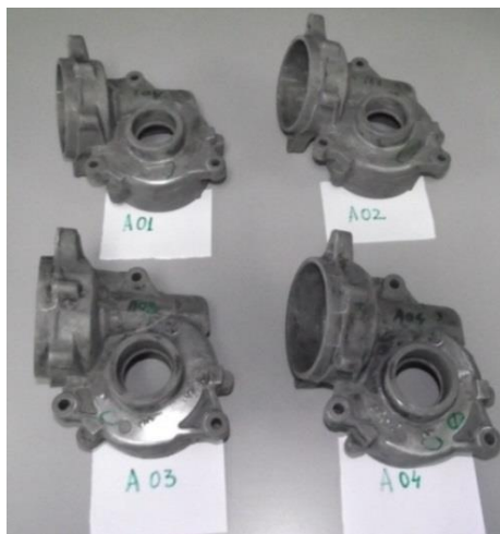
Figura 3.26. Piese HPDC după aplicarea tratamentelor termice T6
