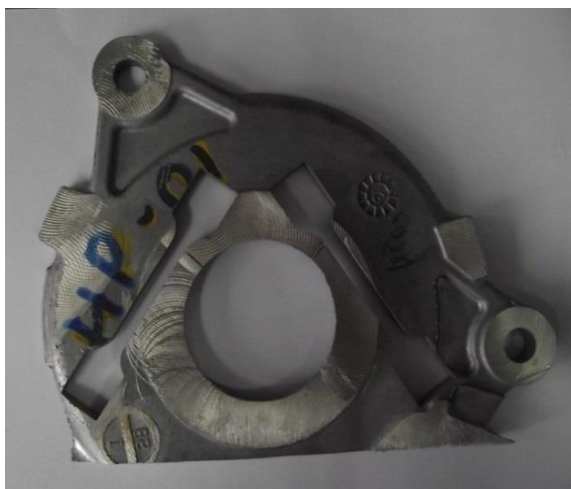
Figura 3.28. Zona piesei din care s-au extras două epruvete pentru realizarea încercărilor la tracțiune
