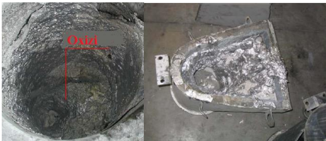
Figura 2.13. Oxizi pe oala de turnare și gura cuptorului de joasă presiune [69]
