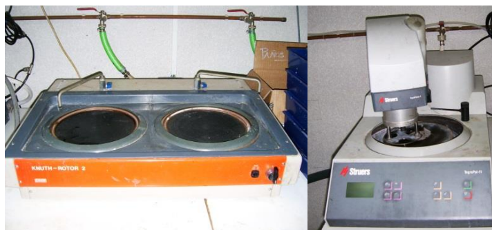
Figura 3.10. Mașinile de șlefuit probe, în stânga Mașina manuală Knuth – rotor 2 Struers și în dreapta, Mașina automată de șlefuit Tegra Poll II Struers
