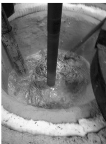
Figura 2.52. Formarea stratului de zgură în urma degazării [42]
