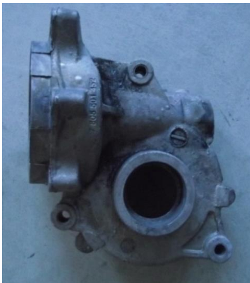
Figura 3.23. Piesa care a primit un tratament termic T6 în Cuptorul Hobersal
