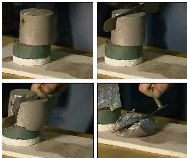
Figura 2.45. Tăierea unui lingou Rheocasting [20]
