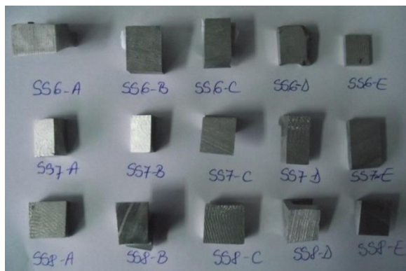
Figura 3.34. Probe obținute din piese fabricate prin procedeul SSR fără tratament termic necesare pentru analiza porozității și a microstructurii
