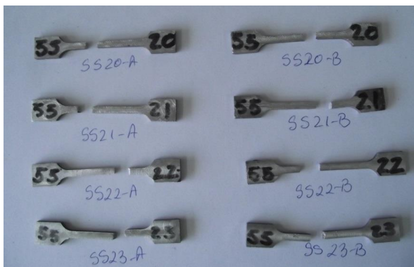
Figura 3.43. Epruvetele SSR cu tratament termic T6 după realizarea testelor de tracțiune
