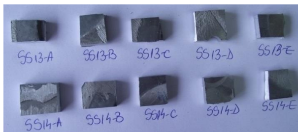
Figura 3.36. Probe obținute din piese fabricate prin procedeul SSR cu tratament termic T5 necesare pentru analiza porozității și a microstructurii
