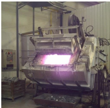
Figura 3.1. Elaborarea aliajului AlSi_9Cu_3 în cuptorul cu reverberație
