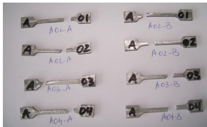
Figura 3.46. Epruvetele HPDC cu tratament termic T6 după realizarea testelor de tracțiune
