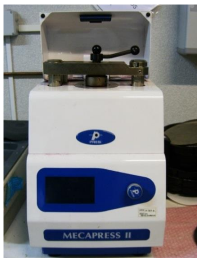
Figura 3.7. Mașina de încapsulat probe Mecapress II
