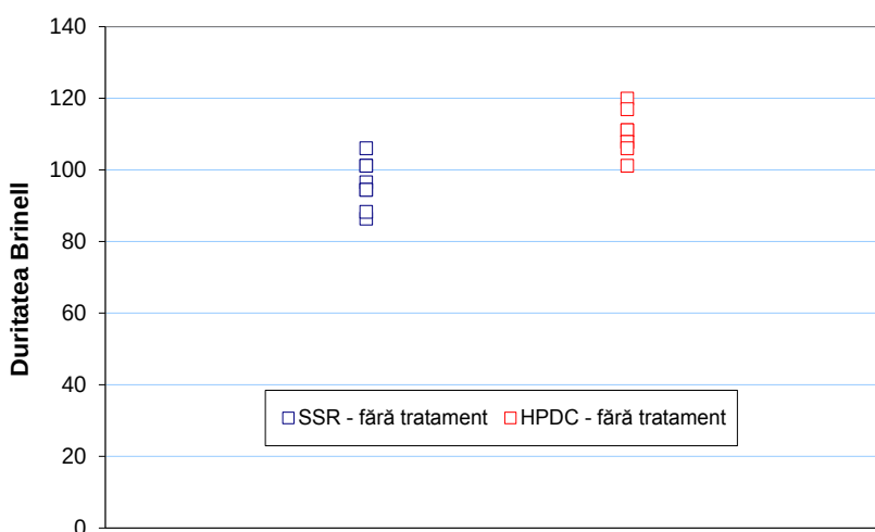
Figura 4.57. Comparație privind duritatea Brinell a aliajului HPDC și SSR în stare brută de fabricare
