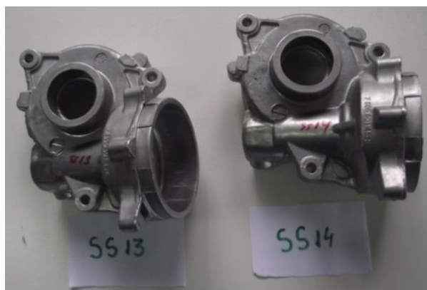
Figura 3.24. Piesele SS13 și SS14 după primirea tratamentului termic T5
