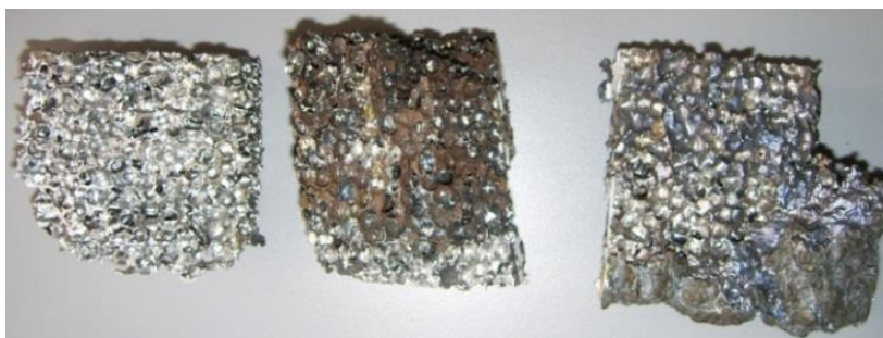
Figura 3.20 Probe selectate din filtru folosit la filtrarea aliajului
