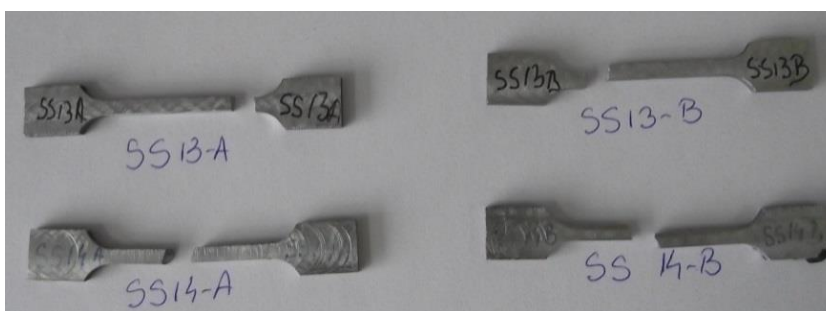
Figura 3.44. Epruvetele SSR cu tratament termic T5 după realizarea testelor de tracțiune
