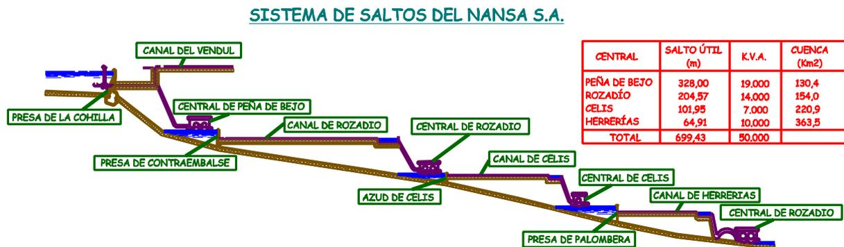
Figura A.1.7.- Perfil longitudinal del aprovechamiento hidroeléctrico.
