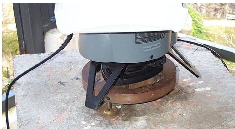
Figura Número IV.24.- Detalle de la nivelación del equipo Leica HDS3000.
