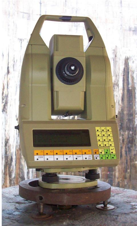
Figura Número IV.1.- Estación topográfica empleada en la auscultación.
