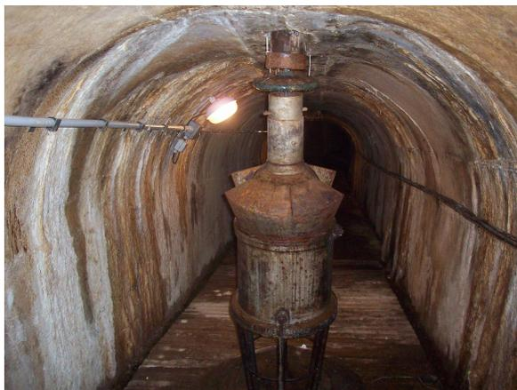
Figura Número IV.12.- Extremo inferior del péndulo donde se encuentra el micrómetro de lectura.
