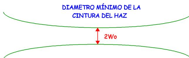
Figura Número III.19.- Definición de la cintura del haz de un rayo láser.
