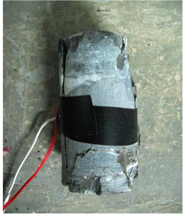
Imagen de la probeta una vez colapsada
