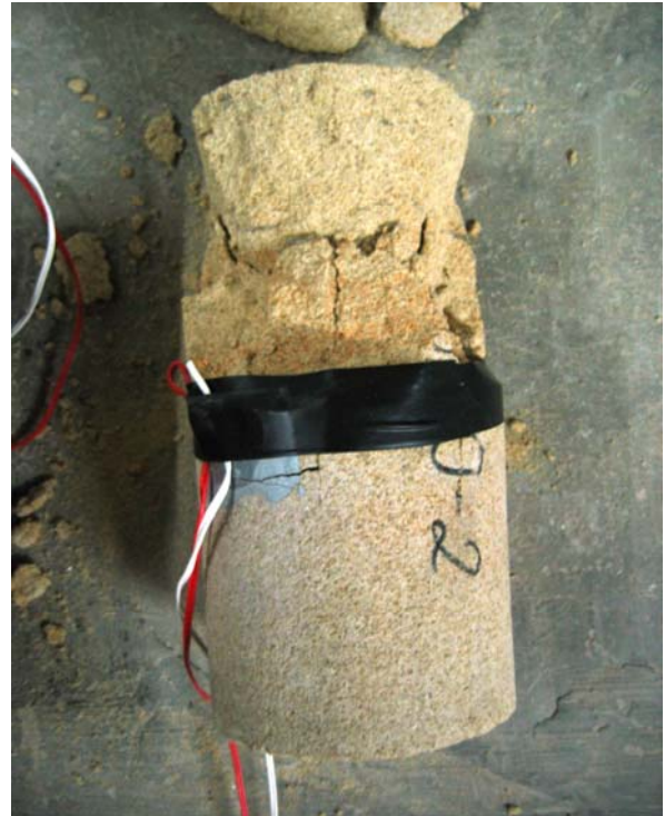
Imagen de la probeta una vez colapsada
