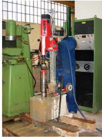
Fig. A7.1: Transporte de uno de los sillares de arenisca que contiene un ensayo de hole drilling, hasta el emplazamiento de extracción de testigos.
