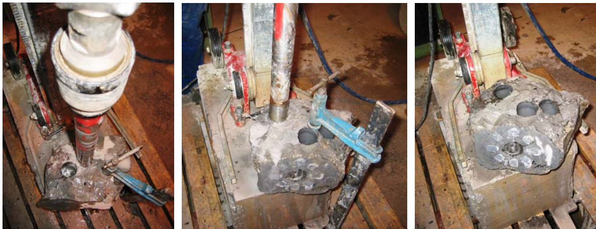
Fig. A7.12 - A7.14: Detalles captados durante el proceso de perforación de dos de las rocas calizas.
