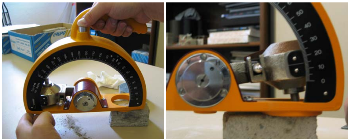
Fig. A2.14 y A2.15: Instantes captados durante la ejecución de dos medidas esclerométricas.
