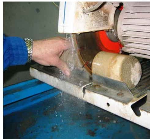
Fig. A7.5: Detalle general de las distintas probetas talladas a partir de los sillares.
