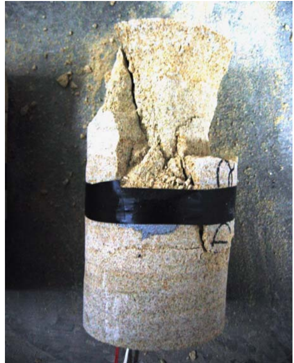
Imagen de la probeta una vez colapsada
