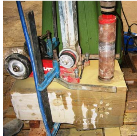
Fig. A7.1: Transporte de uno de los sillares de arenisca que contiene un ensayo de hole drilling, hasta el emplazamiento de extracción de testigos.
