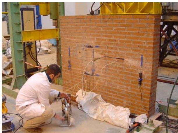
Instante tomado durante la presurización del gato plano.
