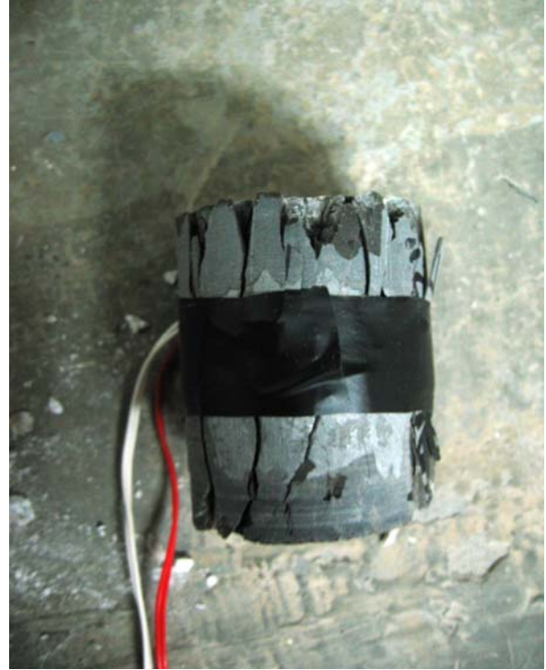
Imagen de la probeta una vez colapsada
