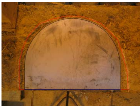
Relación gráfica entre el área de la roza (898.61 \text{cm}^2 ) y área del gato plano GPAd-A Simple (778.56 \text{cm}^2 )
