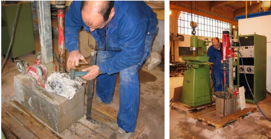
Fig. A7.10: Detalle de la disposición de un mampuesto de roca caliza previamente a la extracción de las probetas.
