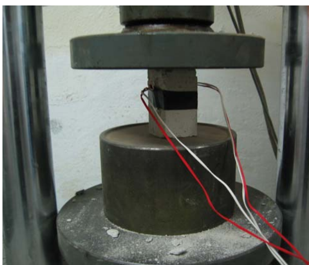
Fig. A2.5: Instante captado durante la ejecución de uno de los ensayos a compresión con registro de deformación vertical y horizontal.
