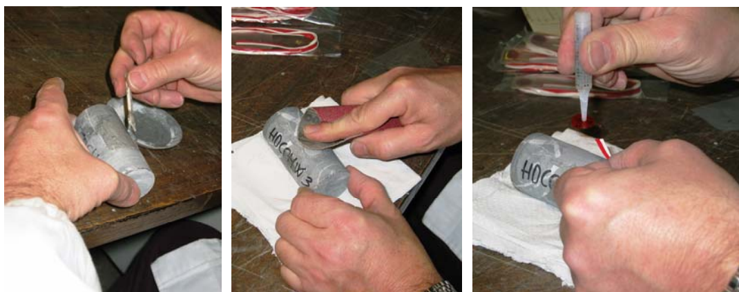
Fig. A7.18 - A7.20: Diferentes detalles del pegado de las galgas extensométricas bidireccionales. En primer lugar se aprecia la disposición de la base de regularización, a continuación el lijado de la misma y, finalmente, el pegado propiamente dicho de una galga.
