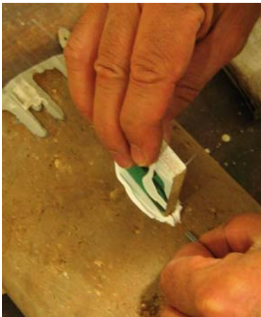
Adhesión y protección de una galga extensométrica a una probeta de tierra mediante silicona.
