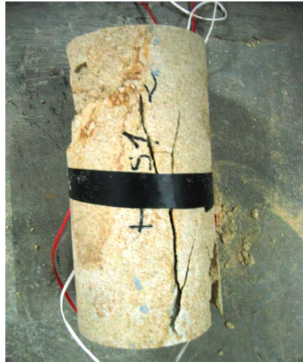
Imagen de la probeta una vez colapsada
