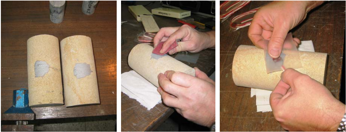
Fig. A7.7 - A7.9: Diferentes detalles del pegado de las galgas extensométricas bidireccionales. En primer lugar se aprecia la disposición de la base de regularización, a continuación el lijado de la misma y, finalmente, el pegado propiamente dicho de una galga.
