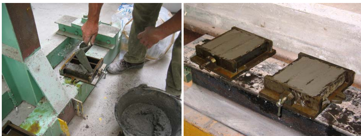
Fig. A2.1: Instante tomado durante la fabricación de las probetas de mortero M-80, en molde prismático de 160 x 40 x 40 mm. Las probetas fueron elaboradas el 8 y 9 de agosto de 2007 (en el caso del M-80 empleado en el muro de ladrillo) y el 28 de diciembre de 2007 (en el caso del M-20 empleado en la sillería y la mampostería).
