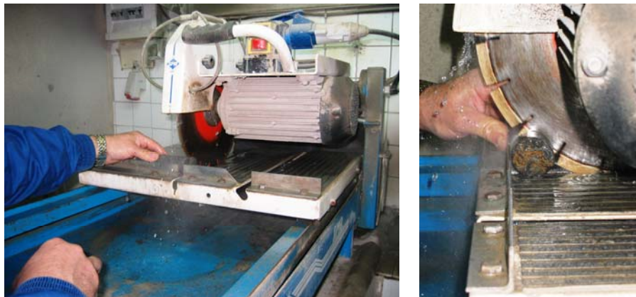
Fig. A7.16 y A7.17: Instantes durante el tallado de una de las probetas de caliza para el posterior ensayo a compresión.
