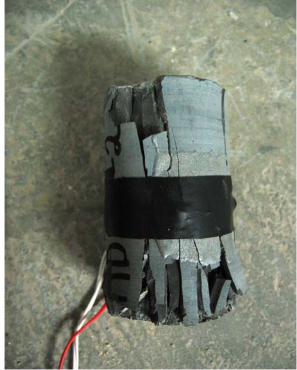
Imagen de la probeta una vez colapsada
