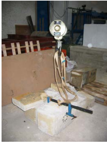
Fig. A7.1: Transporte de uno de los sillares de arenisca que contiene un ensayo de hole drilling, hasta el emplazamiento de extracción de testigos.
