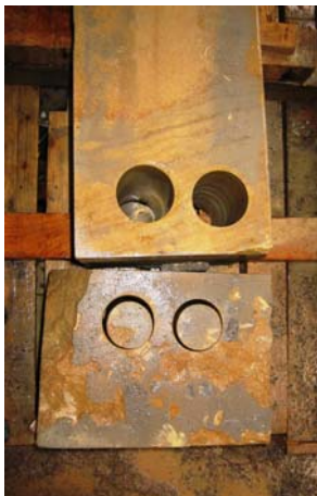
Fig. A7.4: Aspecto de dos sillares con las perforaciones realizadas.
