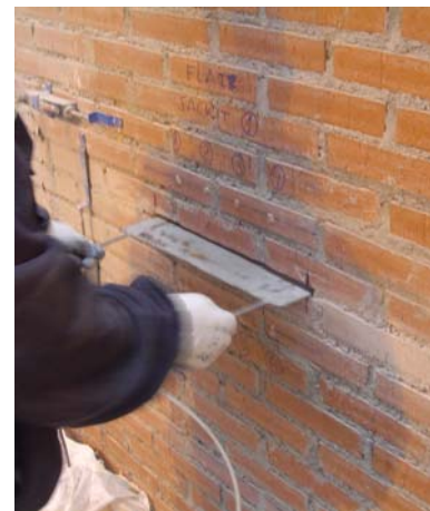
Instante tomado durante la inserción del gato plano rectangular en la roza
