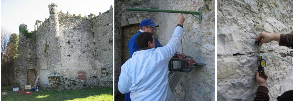
Fig. 5.3.34: Emplazamiento del ensayo de gato plano simple realizado en el Palacio de Riva-Herrera (Santander, Cantabria).
