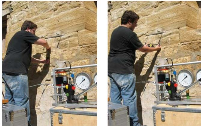
Fig. 5.2.10: Instante tomado durante el control de los desplazamientos correspondientes a los puntos de control horizontal (Longitud base de medida 200 mm).
