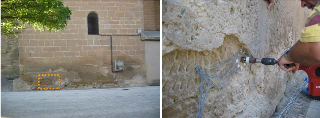
Fig. 5.1.25: Emplazamiento general del ensayo y localización del hole drilling HD-2 dentro del conjunto del muro de fábrica.
