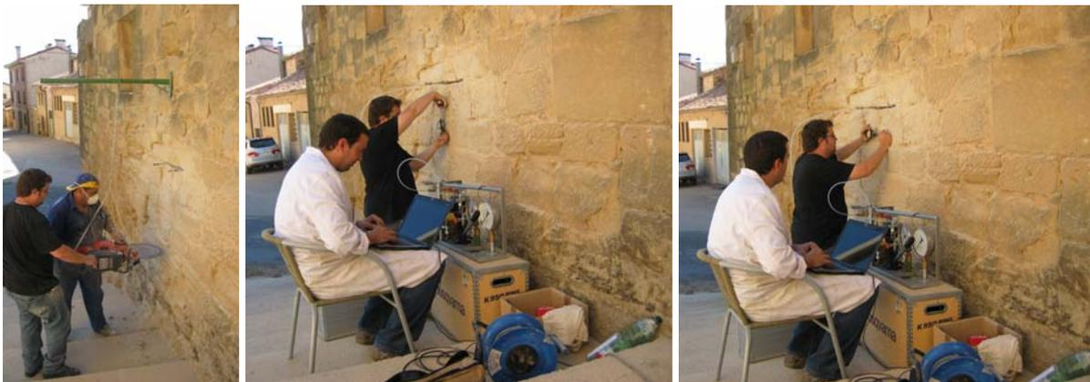
Fig. 5.2.22: Instante tomado durante el proceso de corte para la inserción del gato plano vertical.
