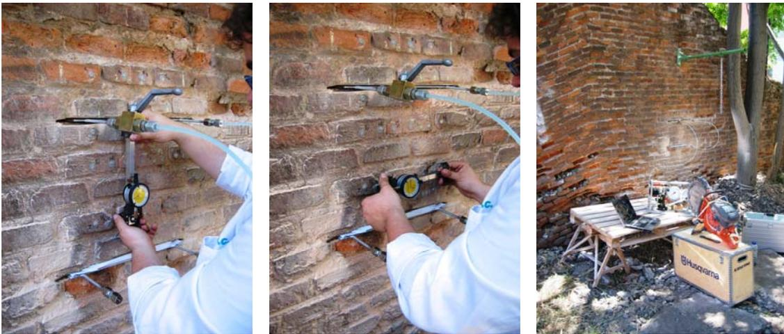
Fig. 5.5.44: Instante tomado durante el control de los desplazamientos correspondientes a los puntos de control vertical (Longitud base de medida 200 mm).
