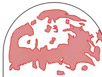
Fig. 5.2.28: Área de contacto entre el gato plano inferior del ensayo FJD-1 y el muro (308.19 cm<sup>2</sup>).
