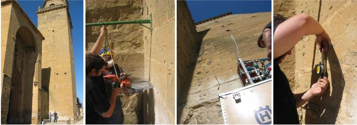
Fig. 5.1.7: Emplazamiento del ensayo de gato plano simple realizado en la hoja exterior del muro portante oeste de la torre de la Iglesia de N<sup>a</sup> S<sup>a</sup> de la Asunción (Zarratón, La Rioja).
