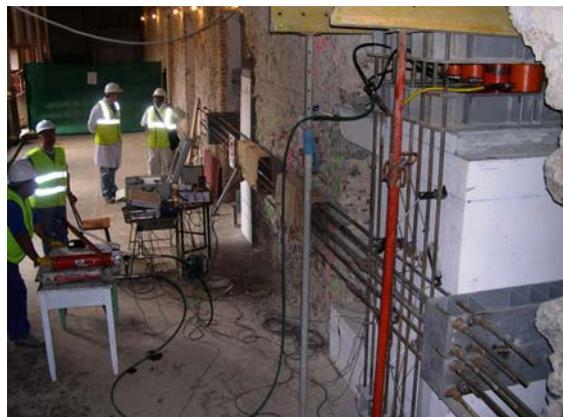
Fig. 5.6.65: Ensayo de corte in situ en la mampostería, bajo un nivel tensional de compresión de 0.57 MPa.
