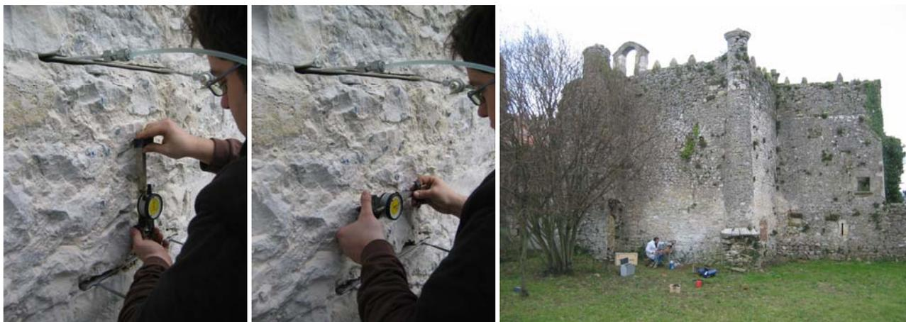
Fig. 5.3.55: Instante tomado durante el control de los desplazamientos correspondientes a los puntos de control vertical (Longitud base de medida 200 mm).
