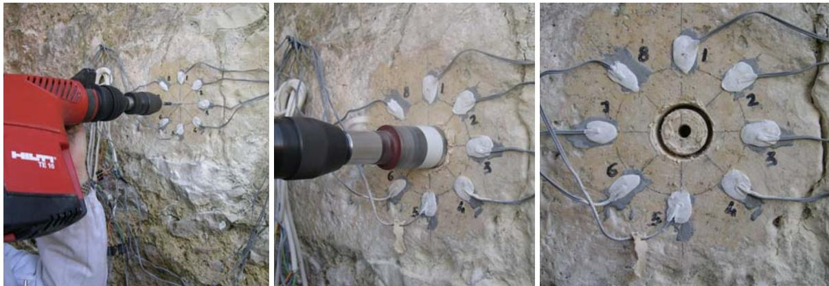
Fig. 5.3.44 y 5.3.45: Instantes captados durante la perforación del agujero. Puede apreciarse la plasticidad de la roca en la que se realizó el ensayo, circunstancia que apunta a su carácter margoso.
