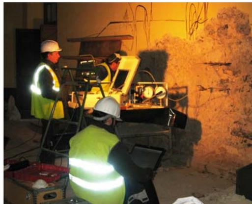
Fig. 5.6.113: Posición relativa del ensayo de gato plano doble FJD-3 respecto a un ensayo hole drilling ejecutado con anterioridad.
