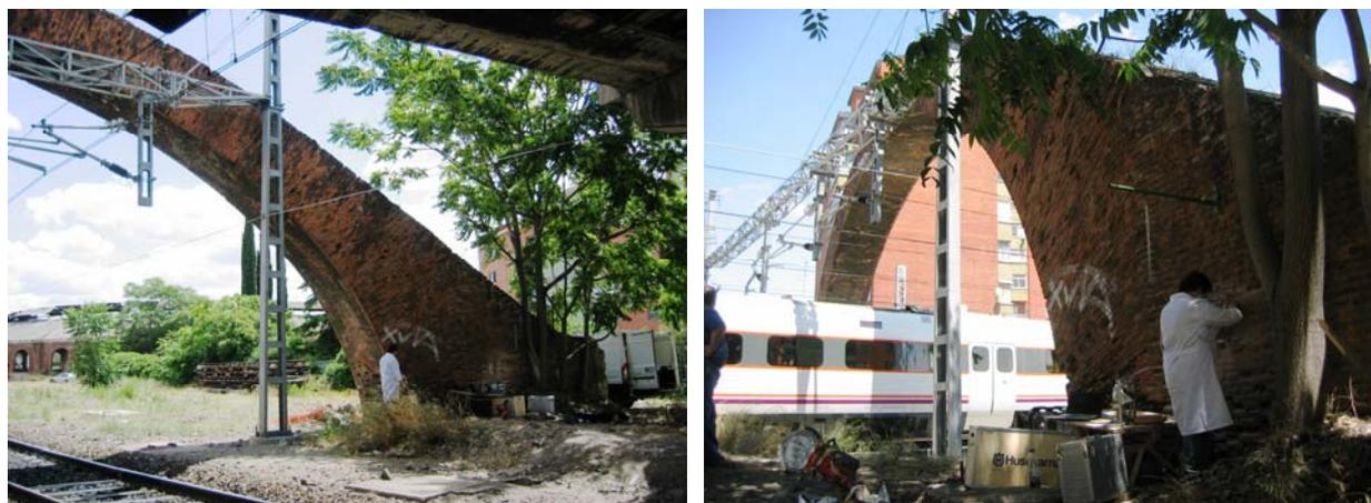
Fig. 5.5.52 y 5.5.53: Instantes durante la ejecución del ensayo de gato plano doble realizado en el estribo Sur del arco de ladrillo sito en la estación de Campo-Grande de Valladolid (España).
