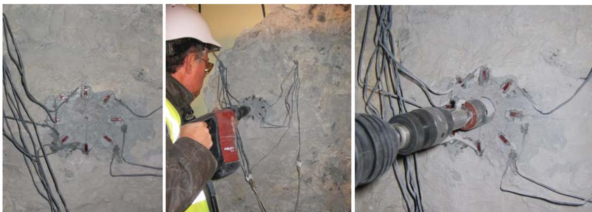
Fig. 5.6.88: Detalle del punto de ensayo HD-4 realizado a nivel de planta baja en el muro central de la crujía Oeste, claustro Oeste, del Seminario Mayor de Comillas (Cantabria, España).
