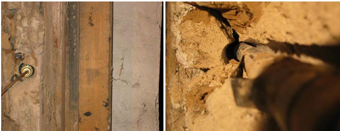
Fig. 5.2.42: Disposición de la sonda mini-presiométrica dentro del componente de adobe.
