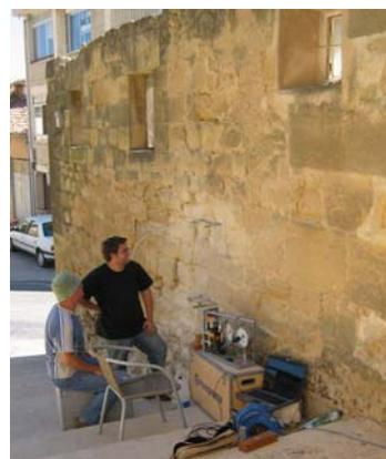
Fig. 5.2.35: Configuración general del ensayo. Puede apreciarse como el muro de fábrica ensayado finaliza en la parte superior de la fotografía, por ello que el nivel de carga existente en la zona de ensayo fuera muy reducida.
