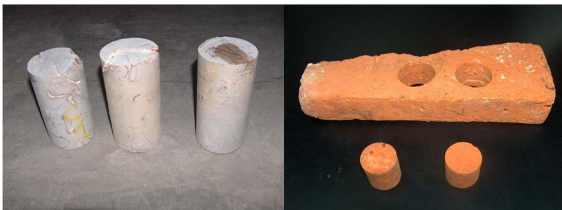
Fig. 5.6.27: Testigos de roca caliza (cortesía Lad Cim-UC).
