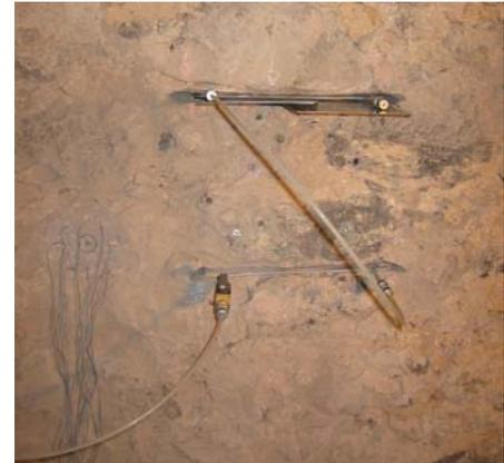
Previamente a la inserción de los gatos planos en la roza, se trató de replantear la superficie de las mismas, de forma aproximada, mediante la medida de la profundidad de corte cada 5 cm. En este sentido en la Fig. 5.6.114 se ilustra el área aproximada, en relación con el gato plano una vez insertado, para la roza superior, y en la Fig. 5.6.115 para el gato plano inferior.
