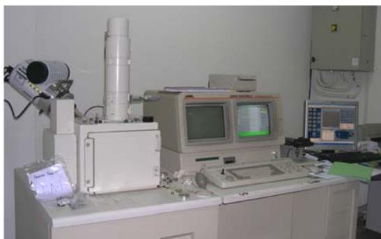
Fig. 5.3.16: Equipo formado por microscopio electrónico de barrido JEOL JSM, a la izquierda y sonda electrónica EDAX a la derecha (cortesía Ladicim-UC).
