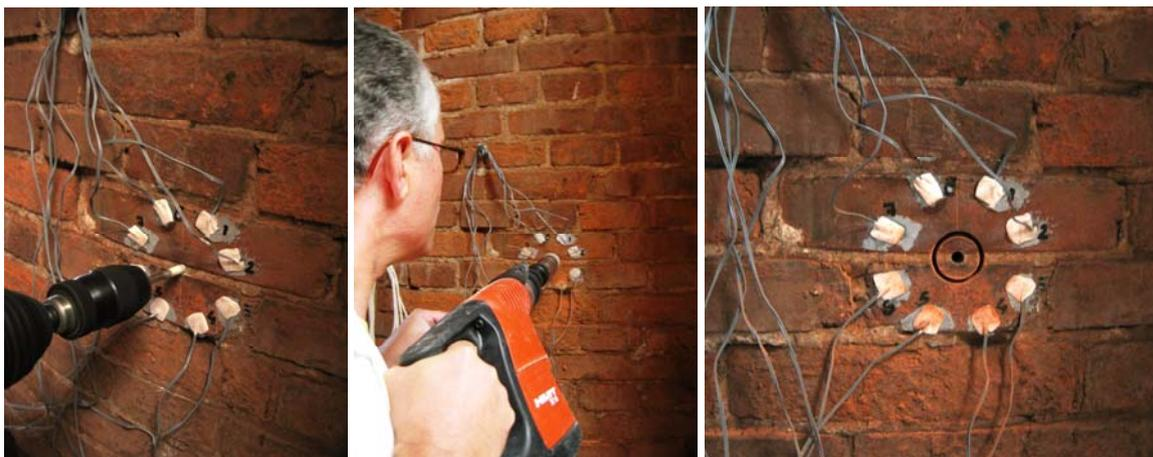
Fig. 5.4.11 y 5.4.12: Perforación realizada para generar la relajación tensional. La profundidad del taladro alcanzó los 36.13 mm.
