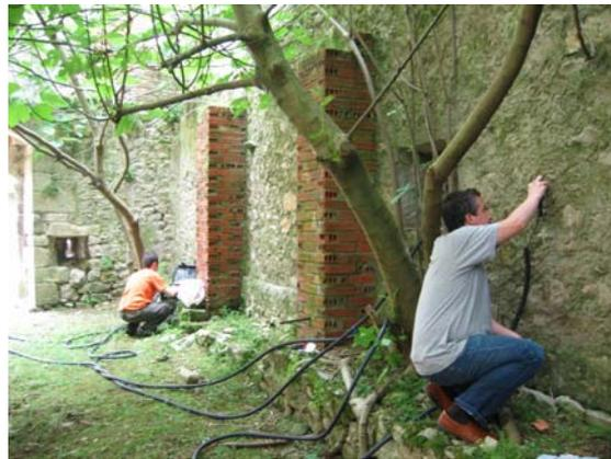
Fig. 5.3.70: Ensayo directo en el muro Sur con el emisor en el interior.
