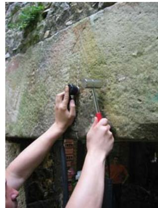
Fig. 5.3.72: Ensayo de impacto eco en el interior del muro Sur.
