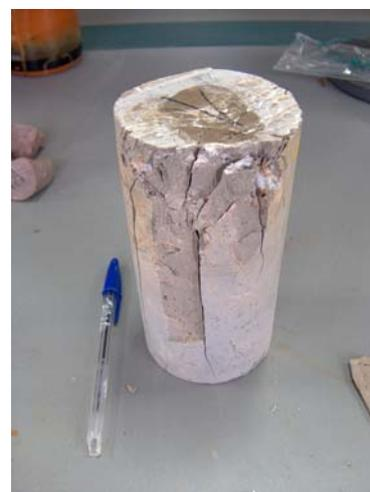
Fig. 5.6.29: Rotura de probeta de arenisca (cortesía Ladicim-UC).
