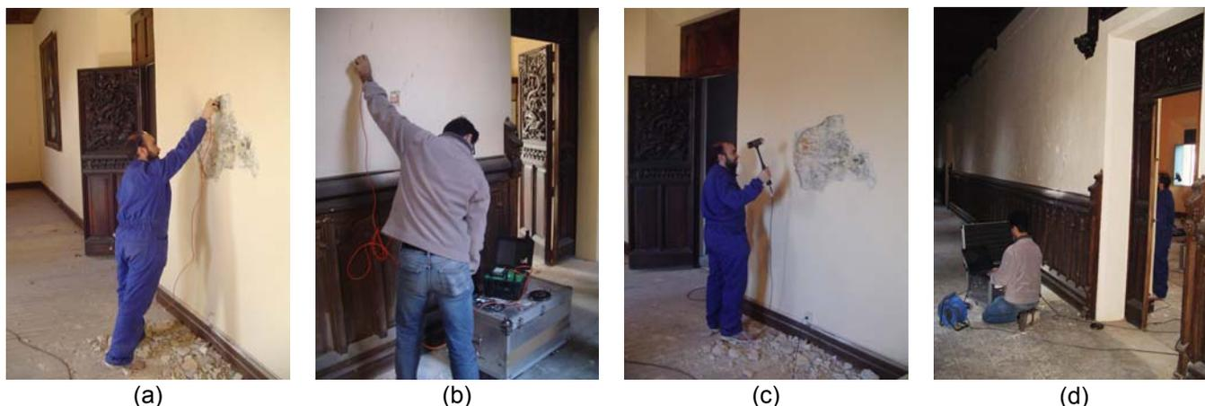
Fig. 5.6.147: Fotografías tomadas durante el desarrollo del procedimiento de auscultación sónica y ultrasónica acometido en la mampostería componente del muro intermedio de la crujía Sur, de 70 cm de espesor, del claustro Este del Seminario Mayor de Comillas (ST-1).
