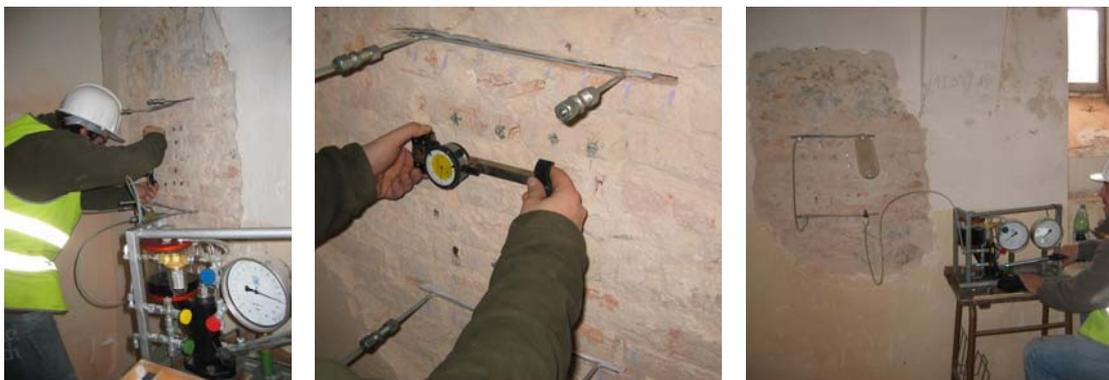
Fig. 5.6.122: Instante tomado durante el control de los desplazamientos correspondientes a los puntos de control vertical (Longitud base de medida 200 mm).
