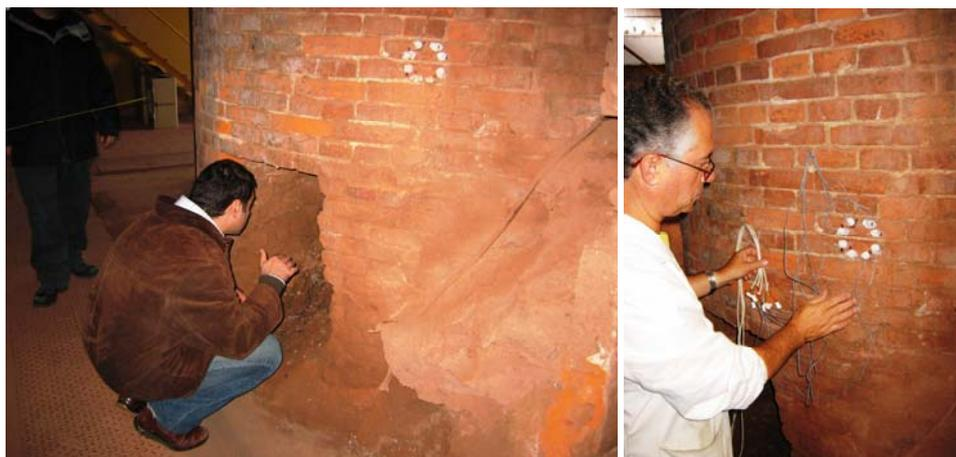
Fig. 5.4.9: Localización del Hole Drilling dentro del conjunto del muro de fábrica, una vez realizado.
