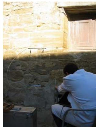
En la Fig. 5.2.7 siguiente se muestra un instante tomado durante el proceso de corte para la inserción del gato plano vertical. Por su parte la Fig. 5.2.8 ilustra un proceso de presurización de los gatos planos, una vez introducidos, correspondiente a uno de los ciclos de carga ejecutados.
