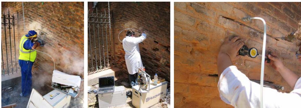
Fig. 5.5.57: Instante tomado durante el proceso de corte para la inserción del gato plano inferior.
