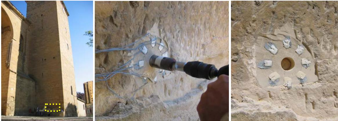
Fig. 5.1.16: Emplazamiento general del ensayo y localización del hole drilling HD-1 dentro del conjunto del muro de fábrica.
