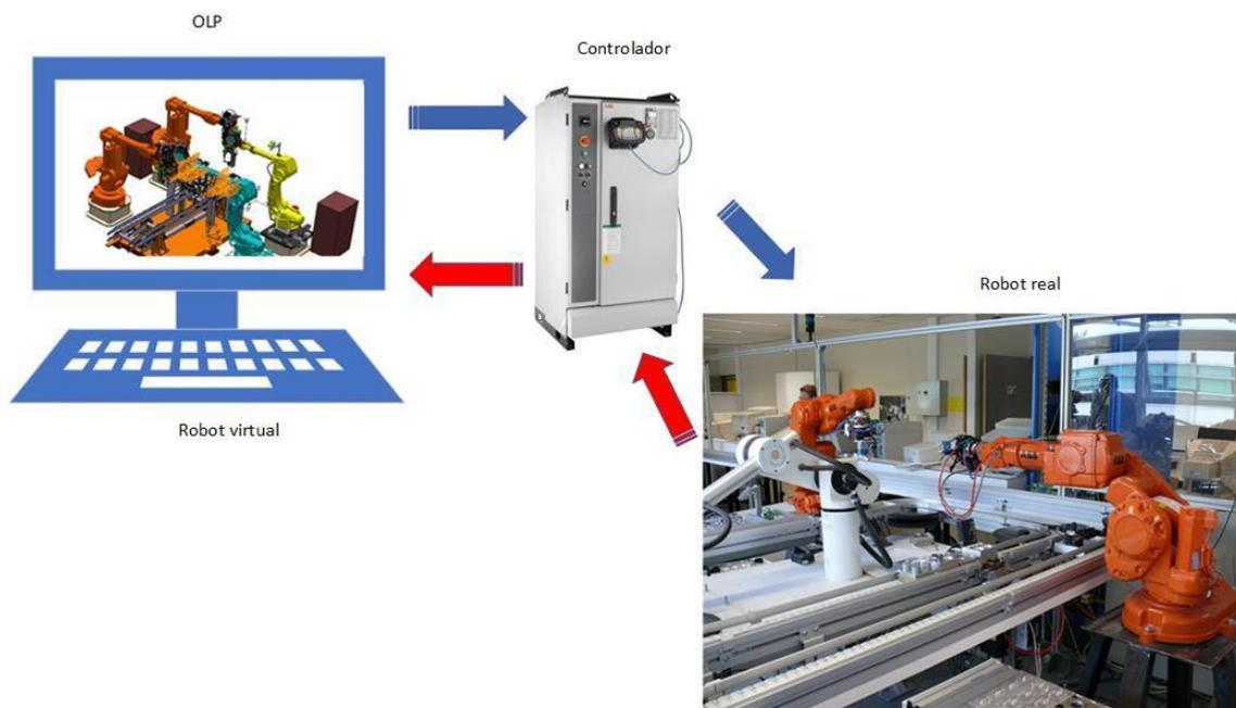
Figura 34: Concepto de control del robot real mediante simulación por ordenador de su gemelo virtual [7]
