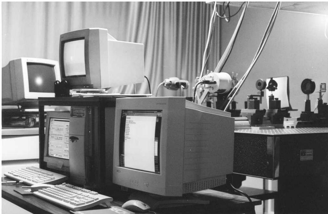
Figura 11.7 Fotografía del monitor de control, sobre el PC que envía la señal al videoprojector, y del PC de adquisición de datos y control de la cámara.
