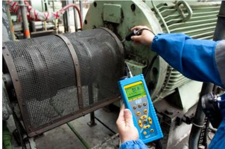
Figura 5. Análisis de vibraciones en equipos
