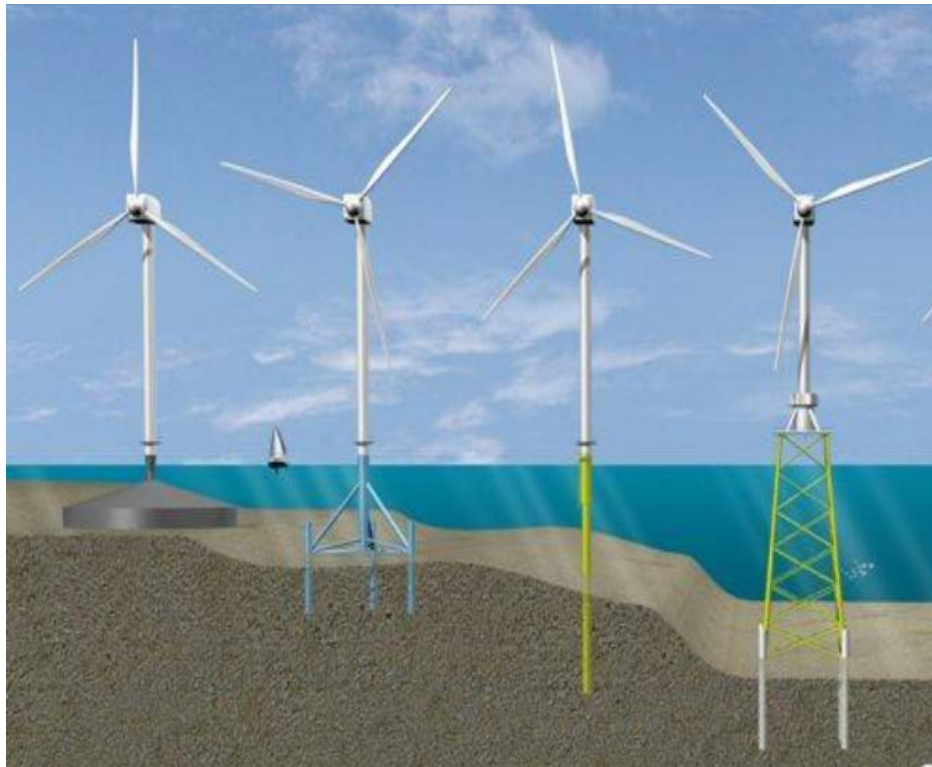
Figura 5: Esquemas de cimentaciones tipo GBF, trípode, monopilote y jacket (Fuente: Ref. [5])
