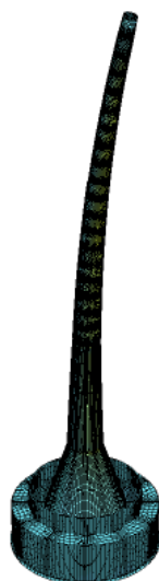
Figura 132: Resultados de la primera frecuencia propia del conjunto con k = 10.000 \text{ kN/m}^3
