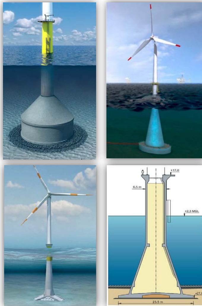
Figura 6: Ejemplos de cimentaciones tipo GBF (Skanska Boskalis Offshore, Vici-Ventus, STRABAG, Ref. [7]; Thornton Bank, Ref. [6])
