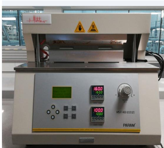
Figura II-32 Equipo de termo sellado – ASPLA.
