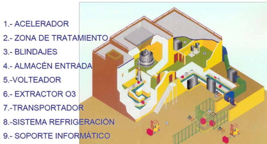
Figura II-11 Planta de Radiación (Ref. imagen Jornada técnica: Reticulación de polímeros mediante radiación ionizante (e-beam) IONISOS-2011).
