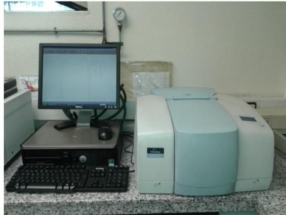
Figura II-16 Equipo de medida de FTIR.
