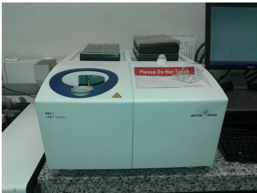
Figura II-14 Equipo de análisis térmico de calorimetría diferencial de barrido disponible en ASPLA.
