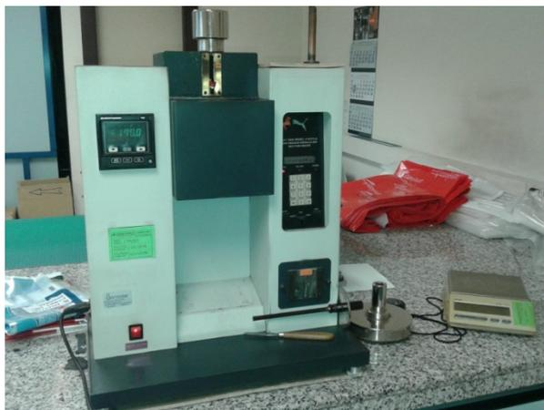
Figura II-13 Equipo de análisis del Índice de fluidez.
