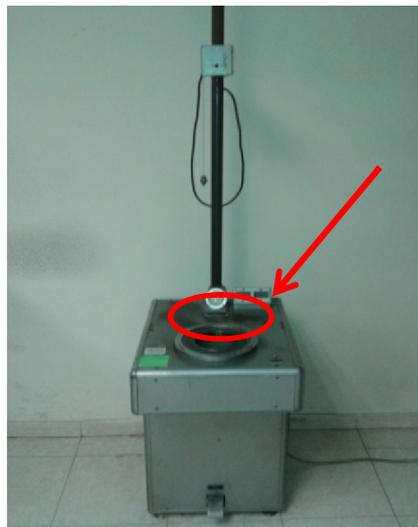
Figura II-29 Equipo de medición de resistencia al impacto – ASPLA.
