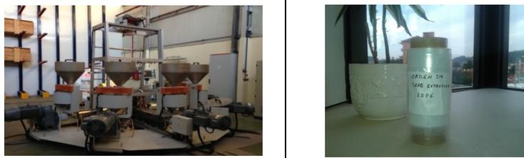
Figura II-5 Extrusora de laboratorio utilizada en la fabricación de la muestra REF314 (izquierda) y forma final de la muestra (derecha).
