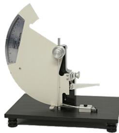
Figura II-30 Equipo de medición de resistencia al rasgado "Elmendorf" – ASPLA.
