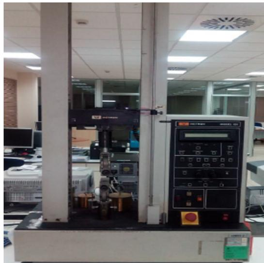
Figura II-33 Máquina universal de ensayos INSTRON. Medición de Fuerza Tracción entre partes soldadas – ASPLA.
