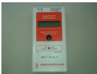
Figura II-34 Equipo de control de la Resistividad Superficial del film – ASPLA.
