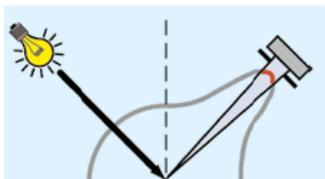
Figura II-23 Medición de la reflexión especular.
