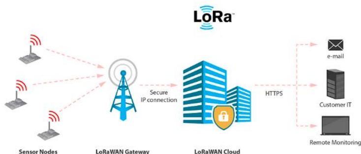
Figura 2.2 Topología tradicional de red LoRaWAN
