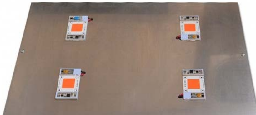
Figura 7.8: Configuración de 4 LED COB sobre una placa
