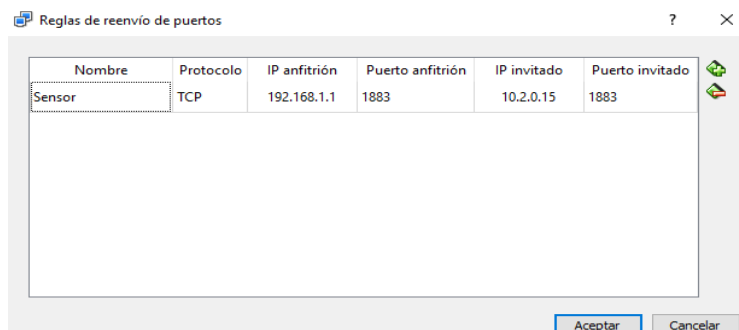
Figura 17. Reenvío de puertos a la máquina virtual
