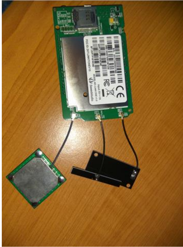
Figura 8. Placa base conectada a las diferentes antenas
