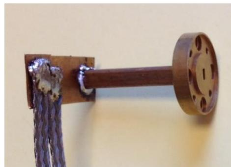
Fig.4. 26. Tramo de guía WR10 terminada en cortocircuito con brida en el extremo opuesto.
