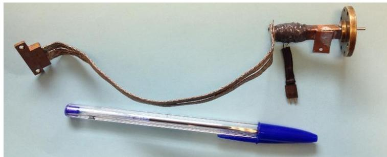
Fig.3. 13. Diseño final de la carga con el anclaje.
