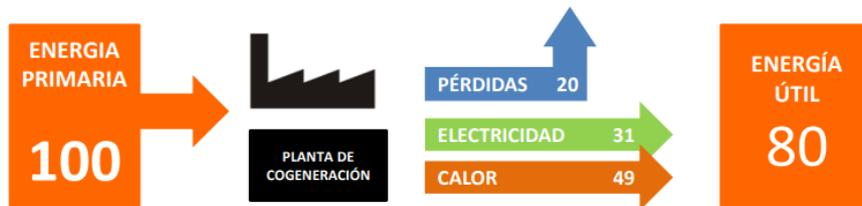
Ilustración 49. Eficiencia de una planta de cogeneración [107]
