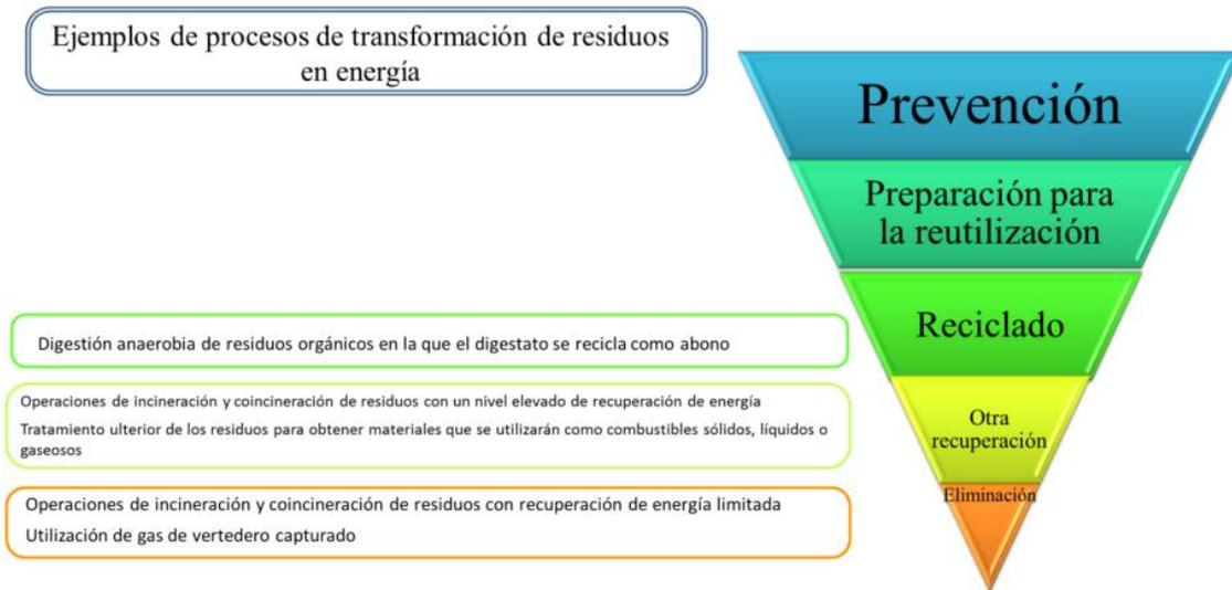
Ilustración 5. Jerarquía de residuos y procesos de transformación de residuos en energía [8]
