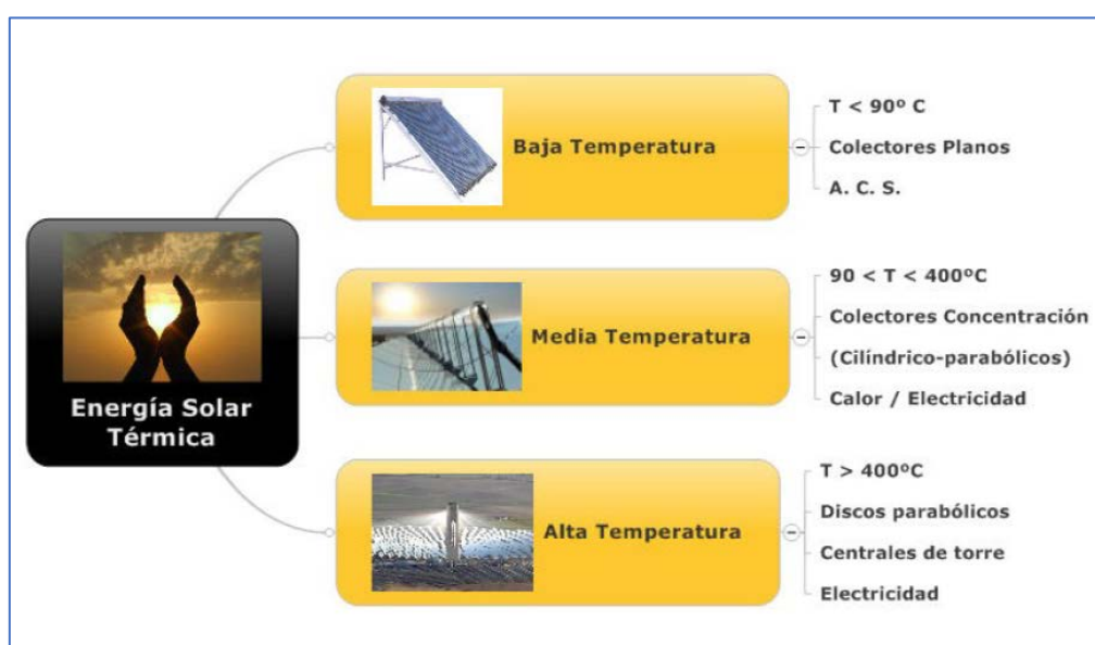
Ilustración 10: Clasificación de la energía solar térmica en función de la temperatura de trabajo. Fuente: Apuntes Universidad de Cantabria
