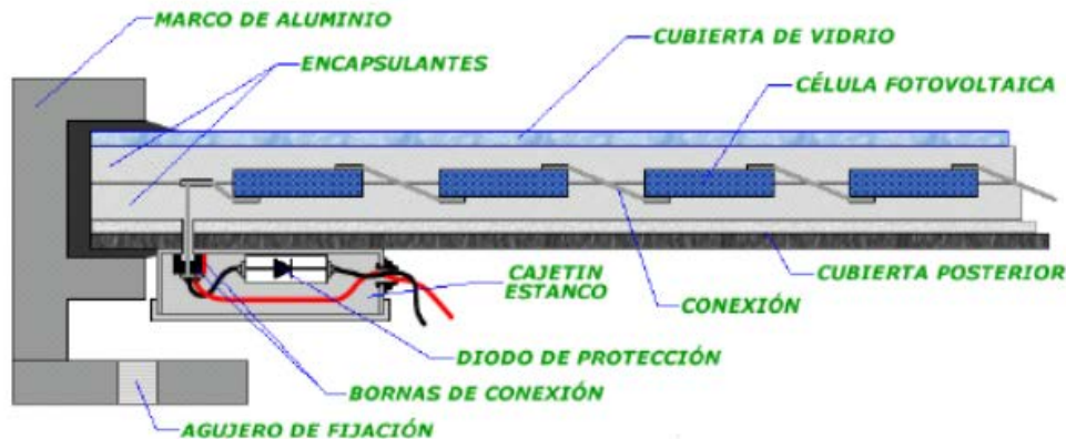
IMAGEN 13: ELEMENTOS DE UN PANEL FOTOVOLTAICO FUENTE: ELISEOSEBASTIAN.COM/DIADOS-EN-LOS-PANELES-FOTOVOLTAICOS/DIODO-FV/
