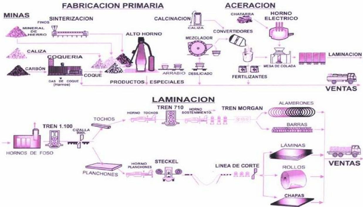
**Figura 23.** Diagrama de flujo de la producción de acero (tomado de la web:
