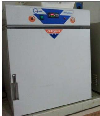
**Figura 46.**Horno para el secado del sólido.
