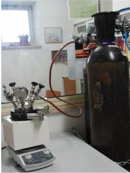
**Figura 41.**Reactor decarbonación.
