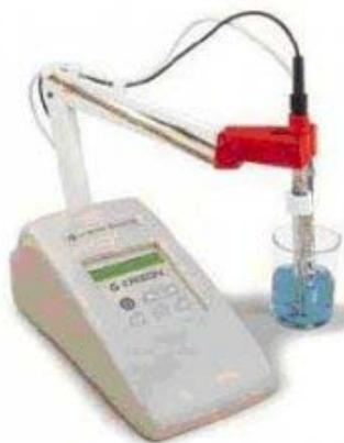
**Figura 45.**Medidor del pH.
