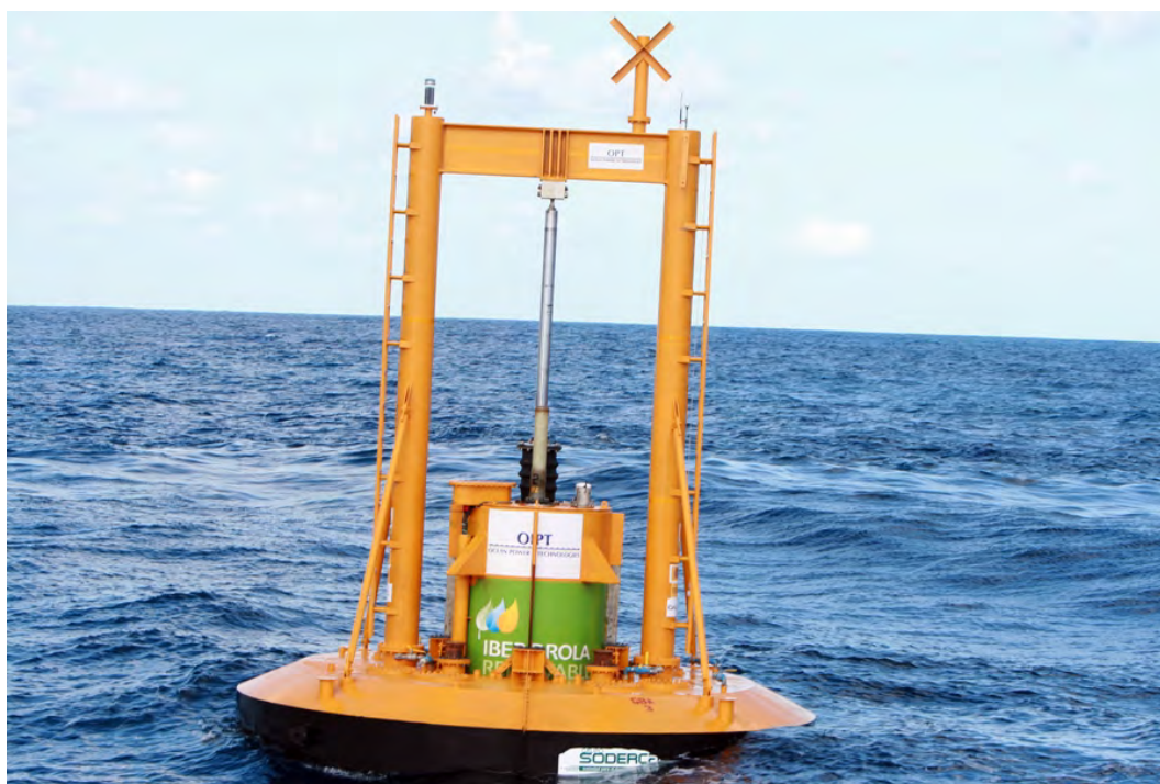
Figura 3.18. Prototipo sistema Undimotriz en Santoña, localidad Cántabra [4]
