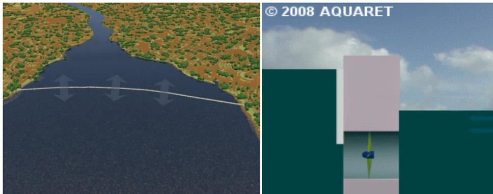
Ilustración 14. Disposición y funcionamiento de la presa de marea. Fuente: aquaret.
