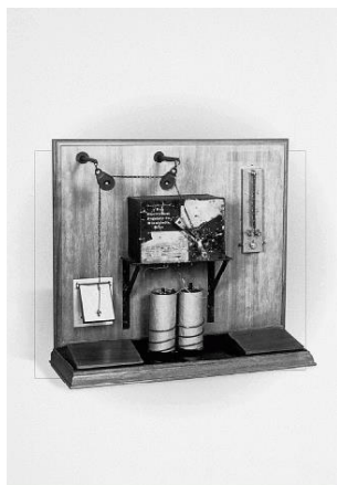
Figura 20. Damper flapper por Albert Butz. Fuente: power-engineering
