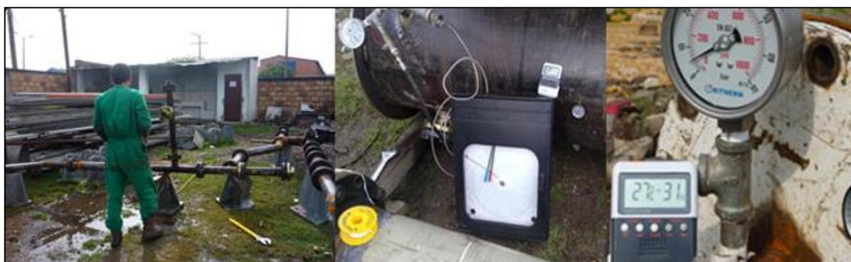
**Figura 3-30. Procedimiento operativo de una prueba hidrostática [28]**
