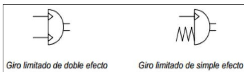
**Figura 3-103. Actuador giratorio, simbología según DIN ISO 1219-1, 03/96 [49]**
