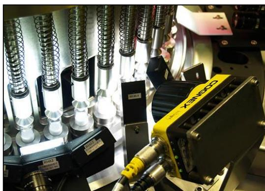
**Figura 3-3. Visión artificial. Control productivo por cámaras [1]**
