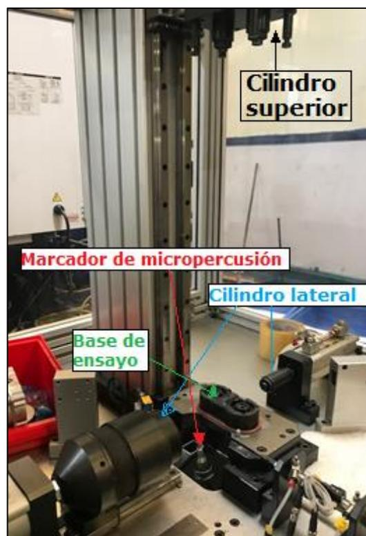
Figura 4-6. Montaje básico de un fugómetro
