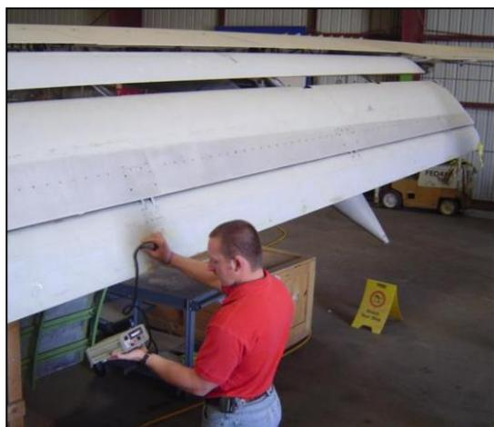
**Figura 3-26. Búsqueda de fisuras en materiales compuestos. [15]**
