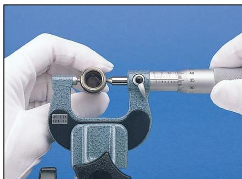
**Figura 3-2. Microscopio estereoscópico [2] Figura 3-1. Medición con micrómetro [4]**
