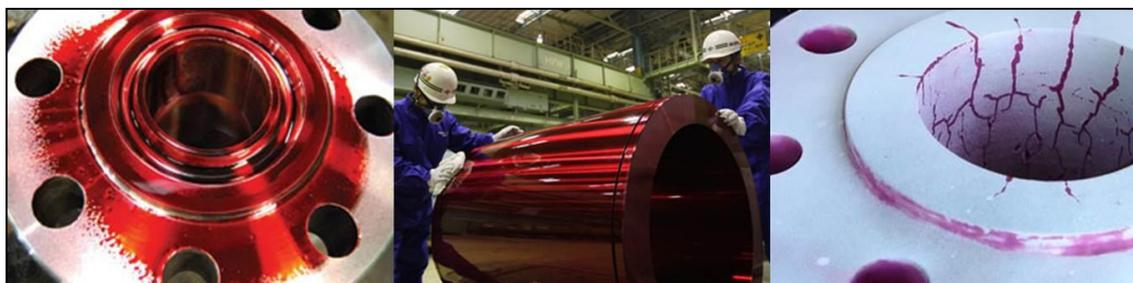
**Figura 3-5. Revelado de grietas mediante líquidos penetrantes [6]**
