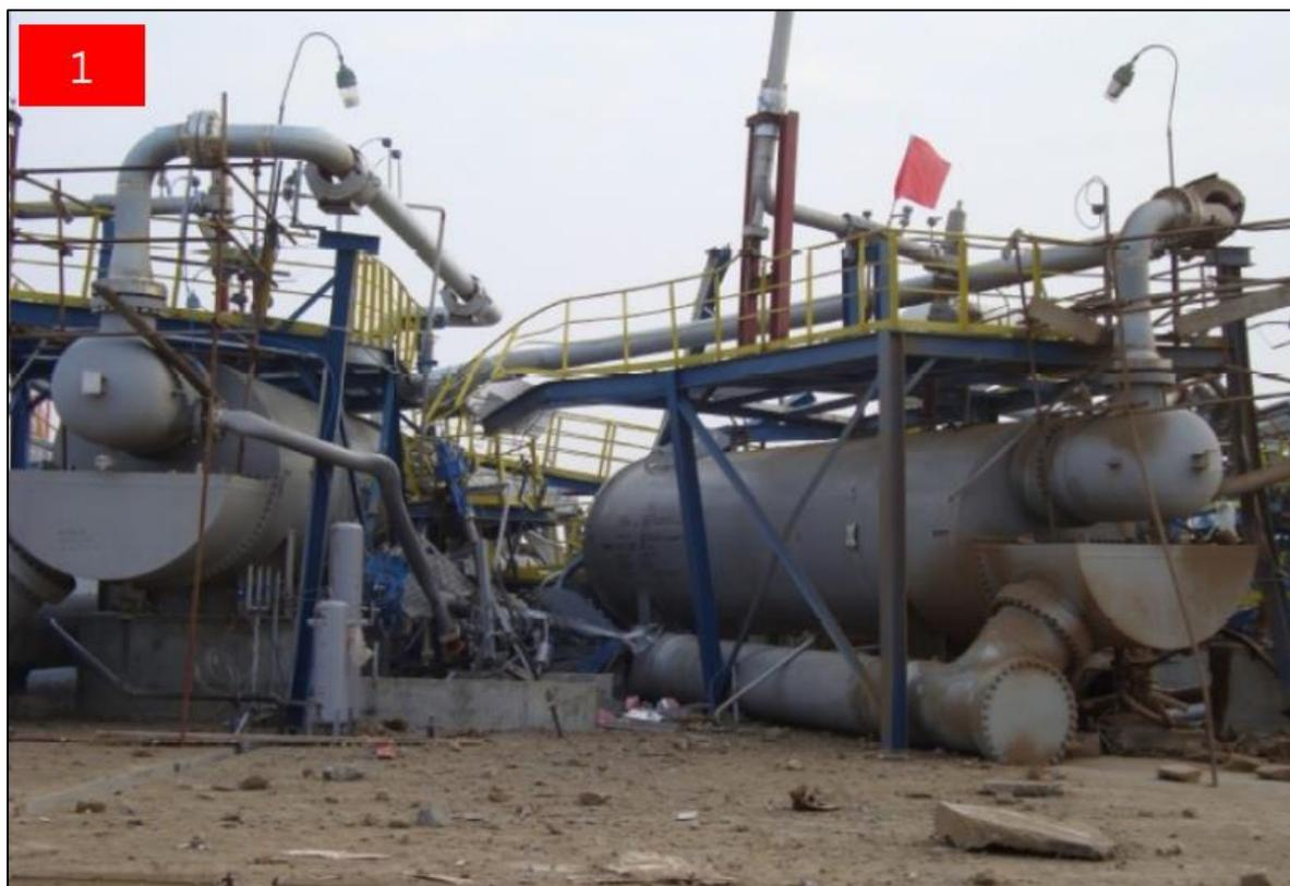
**Figura 3-31. Colapso de una red de almacenamiento y transporte de fluido durante una prueba neumática [27]**
