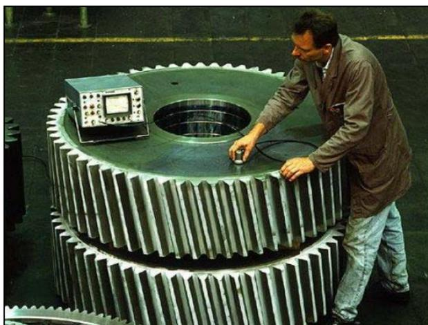
**Figura 3-25. Búsqueda de fisuras en control de calidad de engranajes. [15]**
