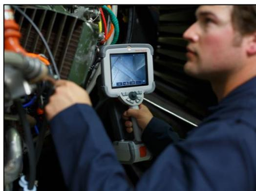
**Figura 3-4. Inspección visual remota. Control álabes turbina con videoscopio [3]**
