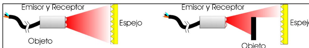
**Figura 3-134. Fotocélula reflexiva con reflector [47]**
