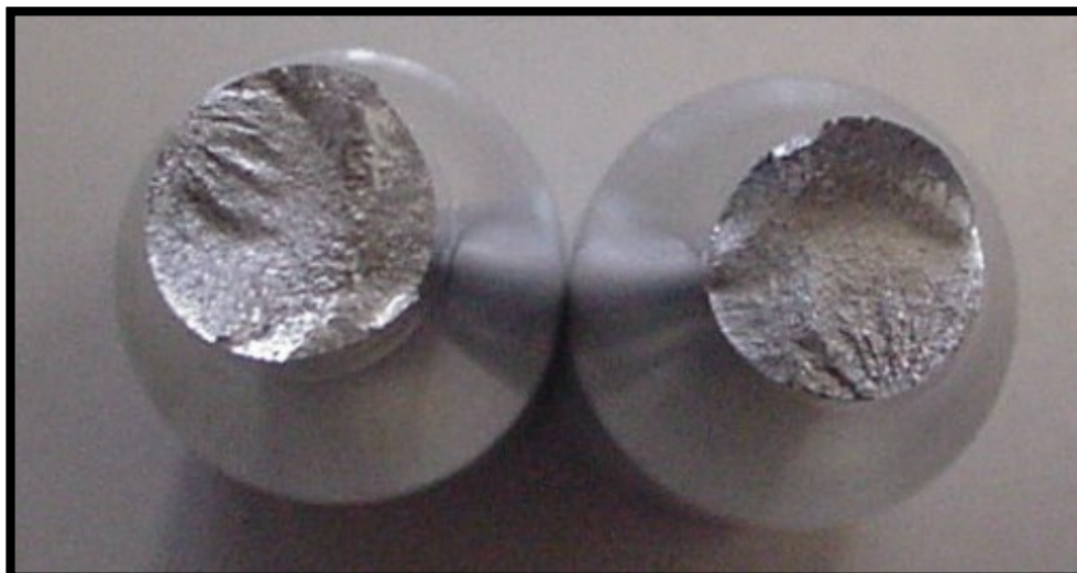
Figura 47: Superficie de rotura por fatiga
