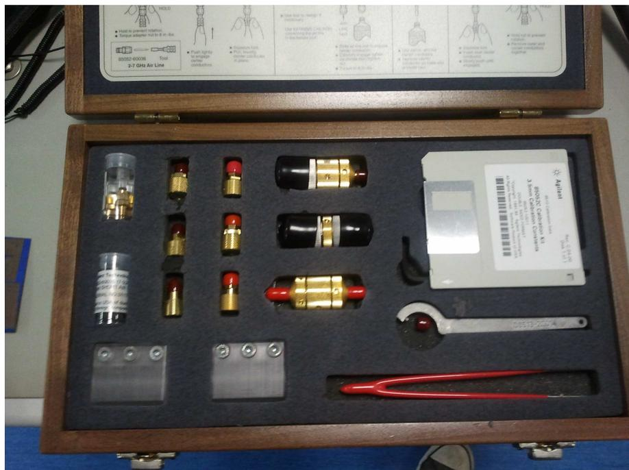
**Figura 68 - kit de calibración**
