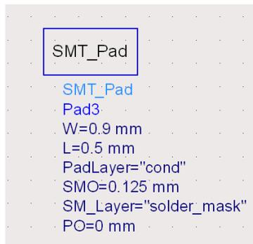
**Figura 48 - Definición del SMT\_Pad de las resistencias**
