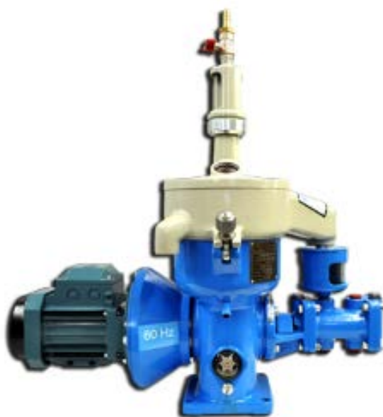
Figura 20. Separador MAB 102 de Alfa Laval. Fuente. Separator , (2018).
