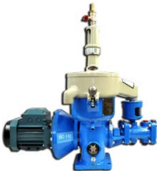
Figura 18. Separador MAB 102 de Alfa Laval. Fuente. Separator , (2018).
