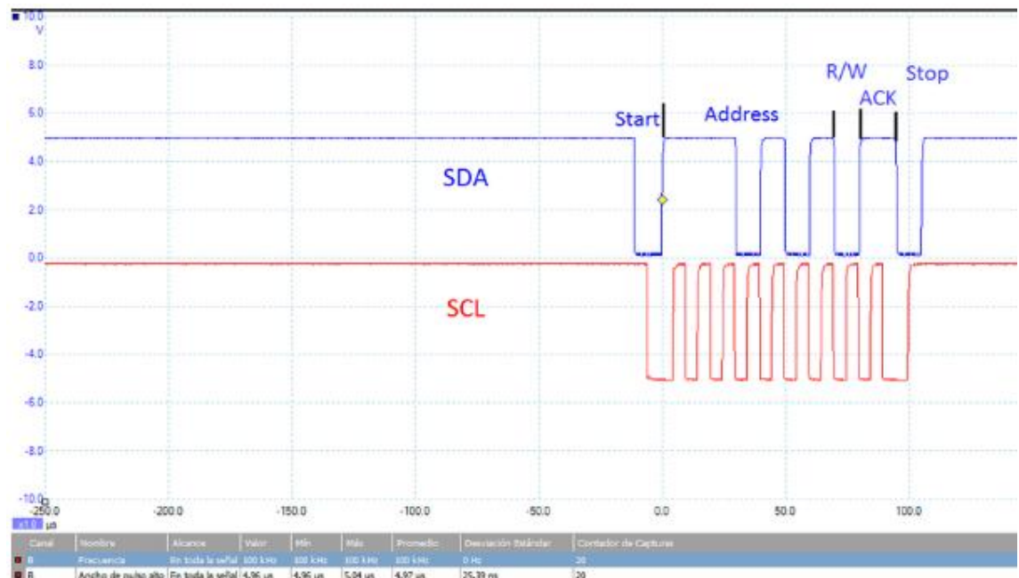
Figura 3.10.2: Proceso de comunicación en I2C
