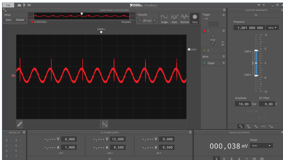
Illustrazione 3.7. Segnale senza trasmissione nel caso in cui la sonda non sia collegata a terra.
