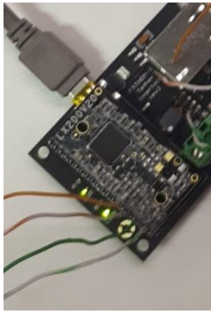
Ilustración 2.8. Conexión de dos cables TX y dos cables RX.
