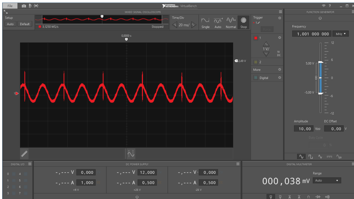
Ilustración 3.7. Señal sin transmisión en el caso de no estar conectada la sonda a tierra.
