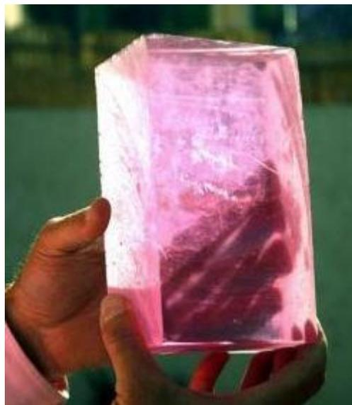
Figura 2.2 Hormigón translúcido con aditivo Ilum y sin árido grueso.
