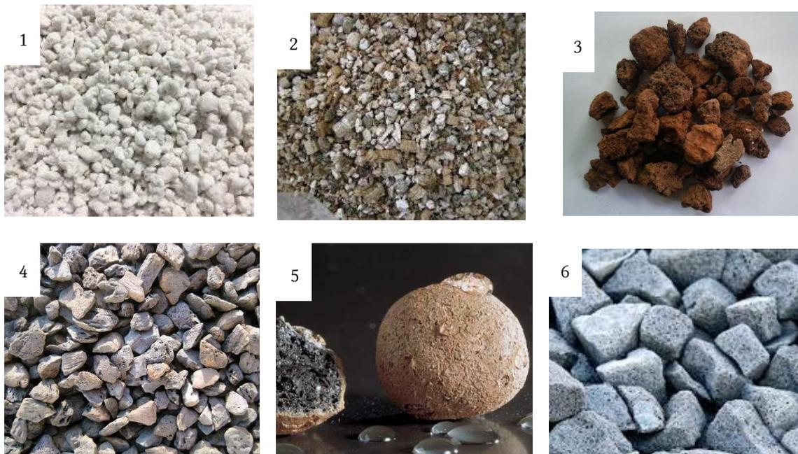
Figura 3.9 Áridos artificiales empleados para hormigón ligero.
