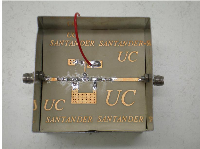
Figura 5.4 Fotografía del circuito de un solo varactor.
