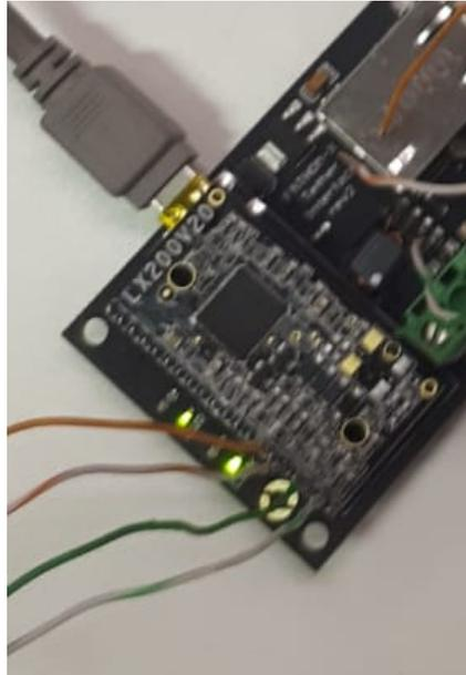
Fig. 20. Conexión de los dos cables TX y los dos RX.
