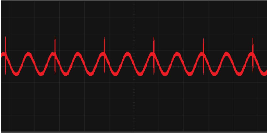
Fig. 30. Señal sin transmisión con la sonda no conectada a tierra.
