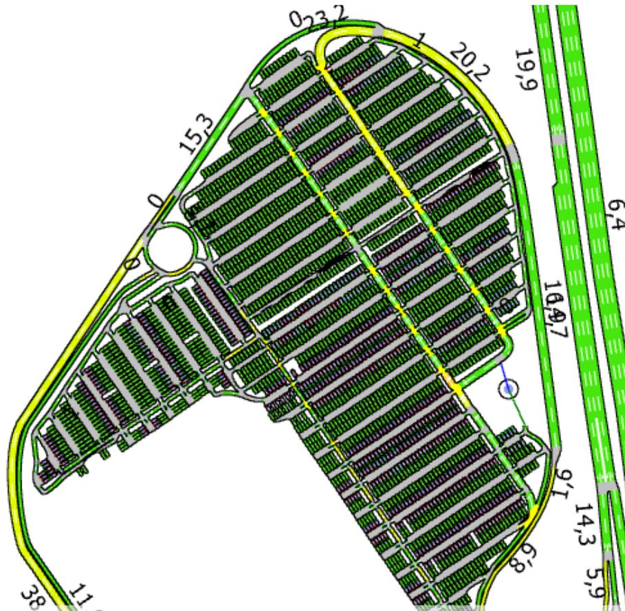
Ilustración 73: Densidad de vehículos en la solución final en el interior del C.C. Aimsun 8.1
