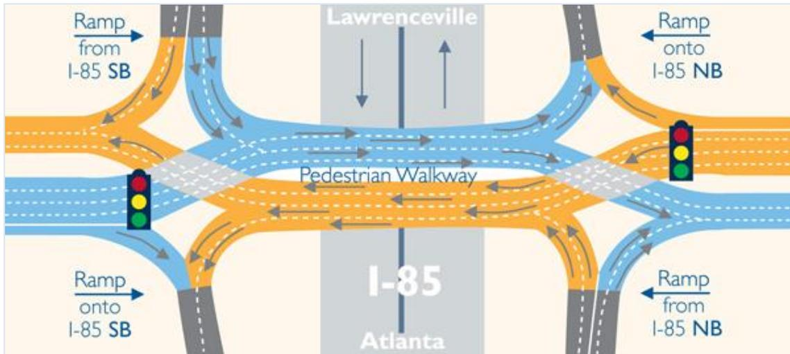
Ilustración 48: Esquema de la circulación dentro de un DDI. Fuente: <https://www.gwinnettcounty.com/portal/gwinnett/Departments/Transportation/DivergingDiamondInterchanges>
