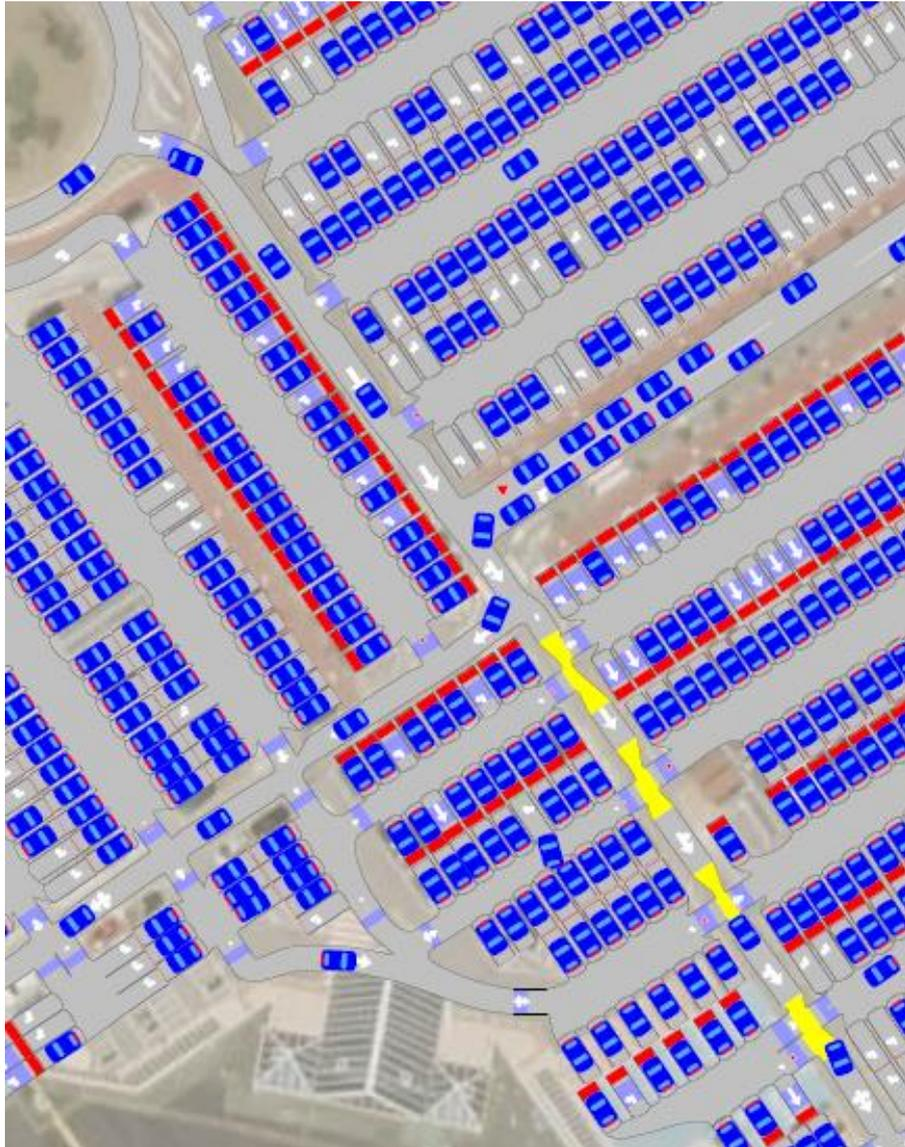
*Ilustración 19: INTERSECCIÓN 2. Representación de las colas en la intersección Aimsun 8.1*
