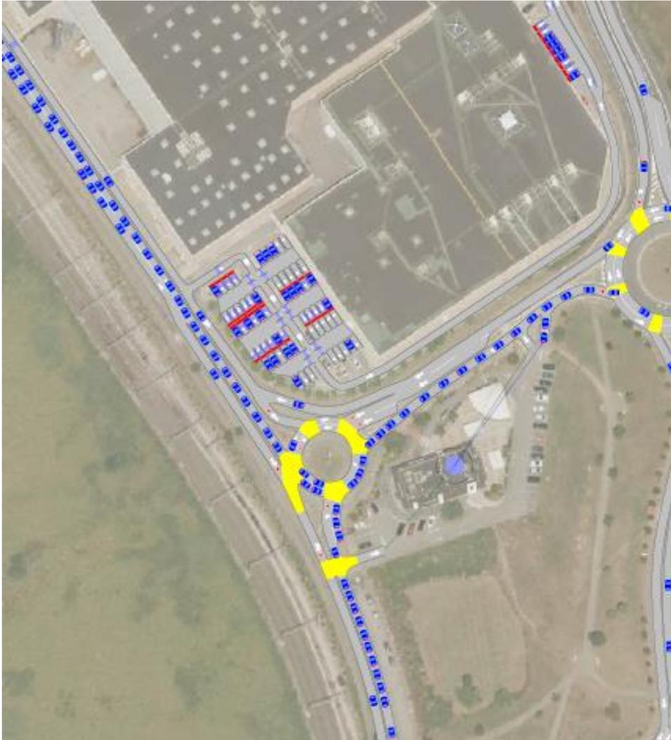
*Ilustración 23: INTERSECCIÓN 3. Representación de las colas en la intersección. Aimsun 8.1*
