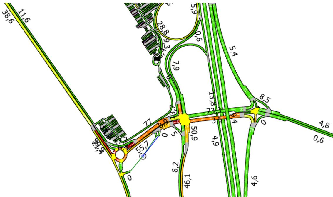
Ilustración 74: Densidad de vehículos en la solución final en el exterior del C.C. Aimsun 8.1
