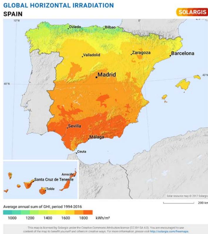
Figura 1. Irradiación solar en España (Solargis, 2017, s.p.)
