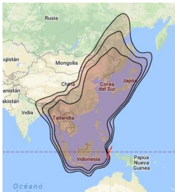
Figura 7: Ejemplo de huella de banda Ku
