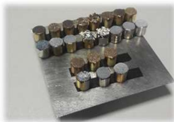
Figura 6. Muestras preparadas para utilizarse en el SEM-EDX
