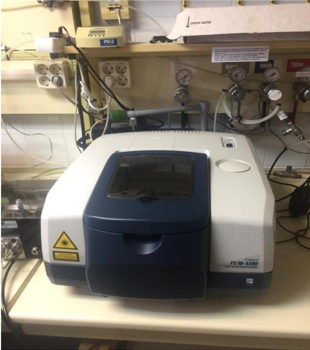
**Figura 6 Espectrómetro IR-FT Jasco 4200LE**
