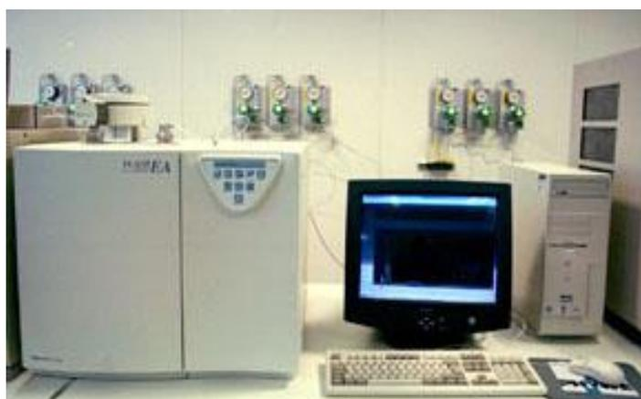
**Figura 7 Analizador Elemental THERMO FINNIGAN modelo FLASH 1112**
