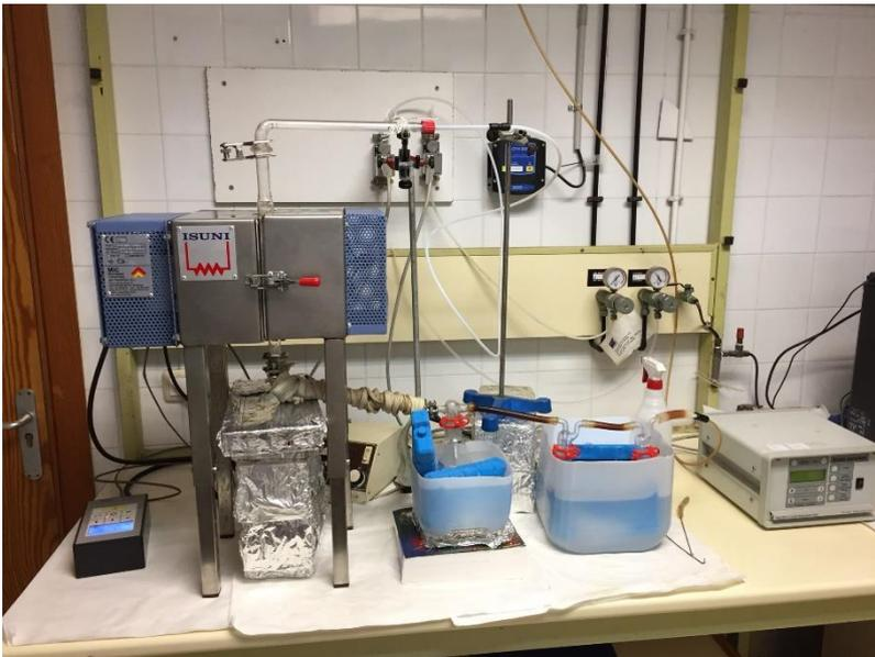
**Figura 9 Planta de pirólisis escala de laboratorio**
