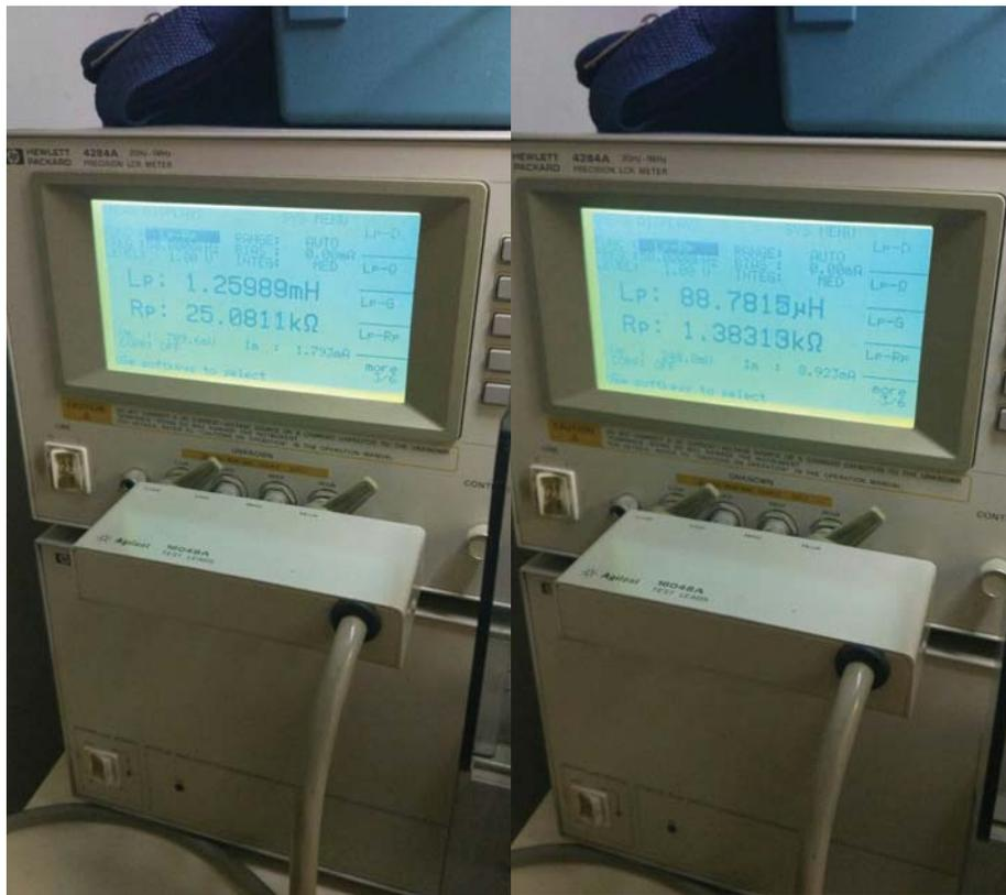
Figuras 69 y 70. Medidas del primario y del secundario.
