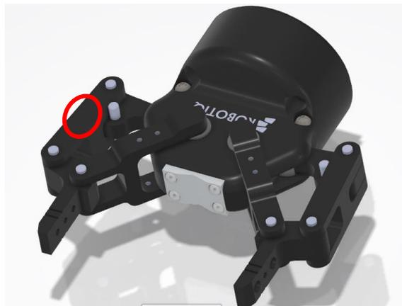
Figura 35 Tope de garra Robotiq
