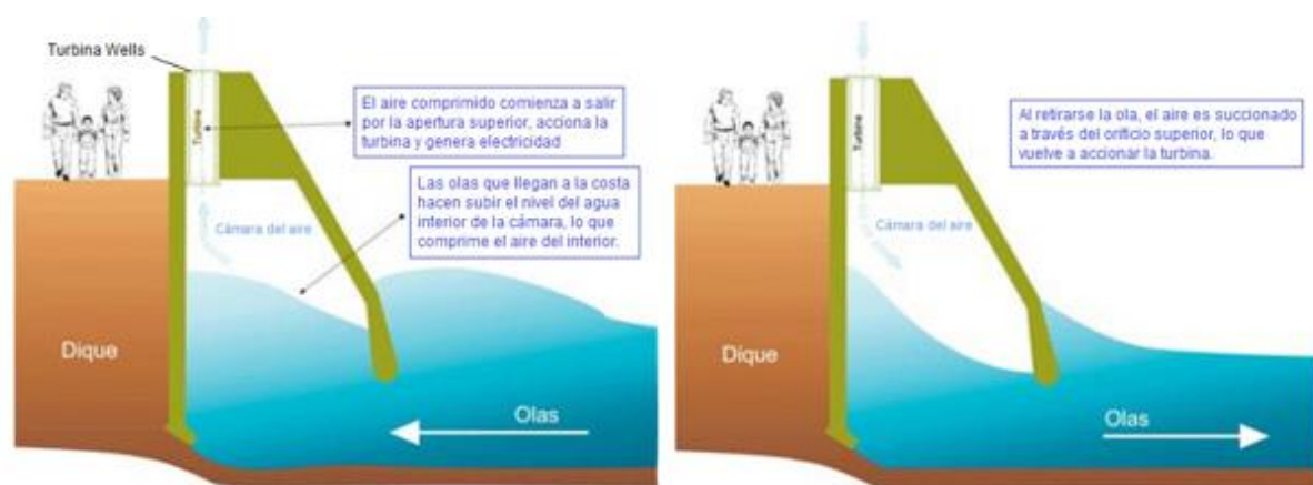
Ilustración 3-3 Esquema de funcionamiento de la central de Mutriku (País Vasco), España. (Fuente: www.caminospaisvasco.com )
