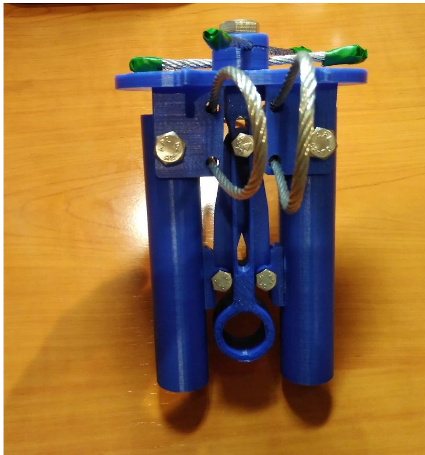
Figura 83. Prototipo nudo k=2 (plegado máximo)
