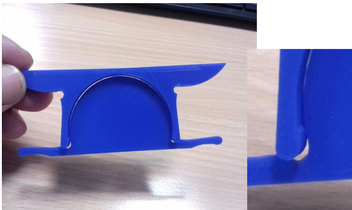
Figura 60. Deficiente acople entre cazoletas (2)
