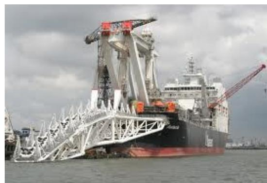
**Barco de tendido de tubería "S-Lay"**
