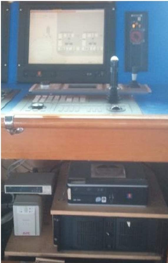
Disposición de la consola principal DP a bordo del Luz de Mar. Véase el display, el conmutador de modo de operación, el panel de control, el ordenador y la UPS (blanca).
