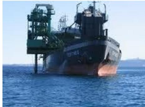
**Tipico barco de vertido de escombro y roca. Véase el ROV que monitoriza y controla la colocación del vertido.**
