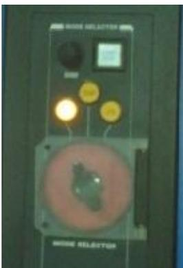
Interruptor instalado en el B/S Luz de Mar para conmutar modo manual, DP y joystick.
