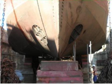
Típico aspecto externo de una hélice de proa instalada y su foto interna.
