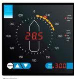
Típico Display de un sensor de viento.
