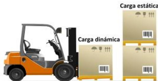
Fig. 32. Croquis representativo de los tipos de carga a los que se ven expuestos los palés en su almacenamiento y transporte. (Fuente: *Rotom.es*)
