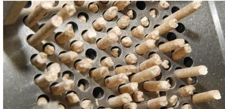
Fig. 9. Obtención del pellet al paso por la matriz (<http://millingandgrain.co>)
