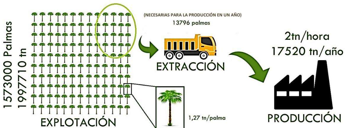
Fig. 37. Esquema representativo de la operación de la planta de procesamiento de biomasa, relacionando el recurso disponible con producción. (Fuente: Elaboración propia)
