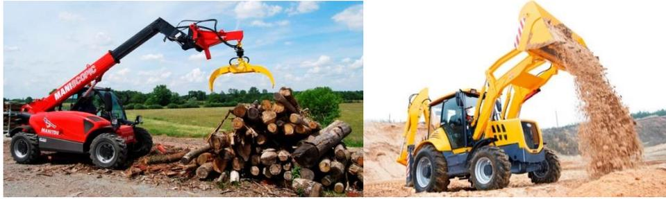
*Fig. 29. Pinza cargadora de troncos y retroexcavadora.
