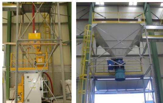
Fig. 10. A la Izda se muestra el ensacado y a la Dcha la carga telescópica. (Fuente: Pelletsasturias.com)
