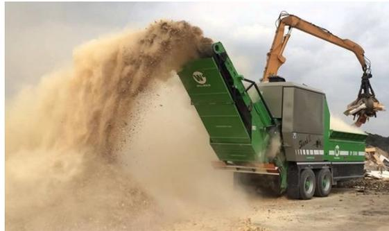
*Fig. 27. Trituradora móvil por medio de remolque, de martillos oscilantes y cuchillas de trituración secundaria. Descarga por cinta transportadora hasta 4,5 m de altura. (Fuente: Agroforestalediciones.com)*
