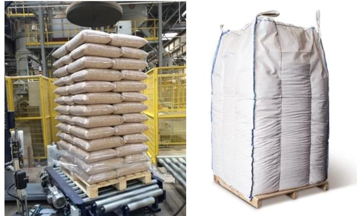
Fig. 21. A la izquierda se muestra un pallet de sacos de 15kg apilados y en fase de embalaje para ser distribuidos. En la imagen derecha se observa el aspecto final del Big-bag de 1tn.
