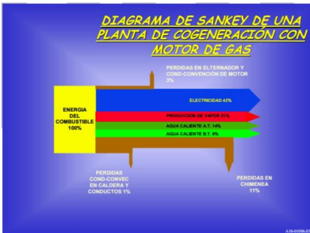
Ilustración 1. Diagrama de sankey de una planta de cogeneración con motor de gas
