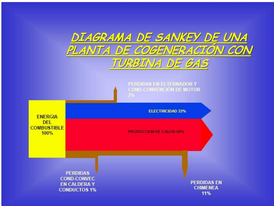
Ilustración 2. Diagrama de sankey de una planta de cogeneración con turbina de gas
