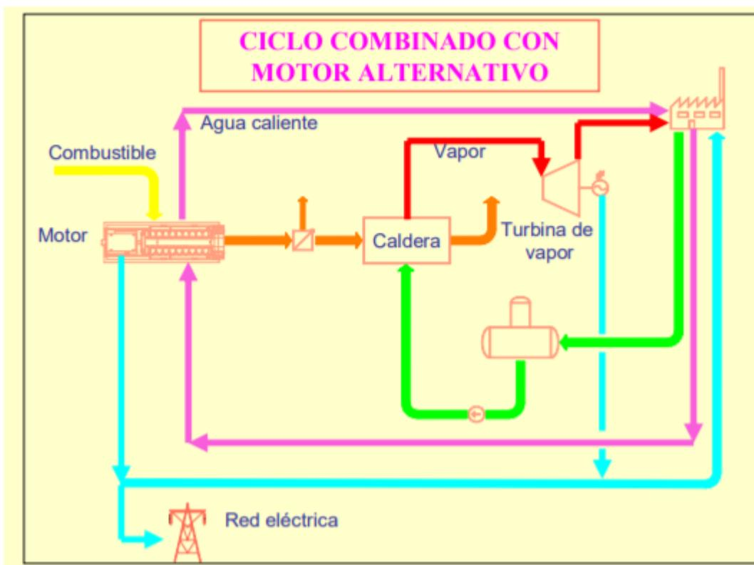
Esquema 4. Planta de ciclo combinado con motor alternativo
