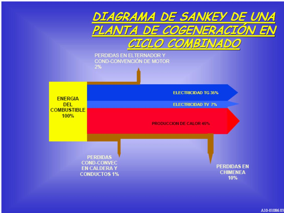
Ilustración 3. Diagrama de sankey de una planta de cogeneración en ciclo combinado
