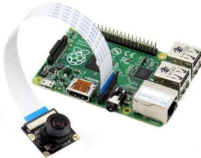
*Ilustración 7 Cámara Raspberry pi v1.3*
