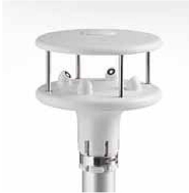
FIGURA 3.12: Imagen de la anemoveleta de ultrasonidos ubicada en la estación meteorológica
