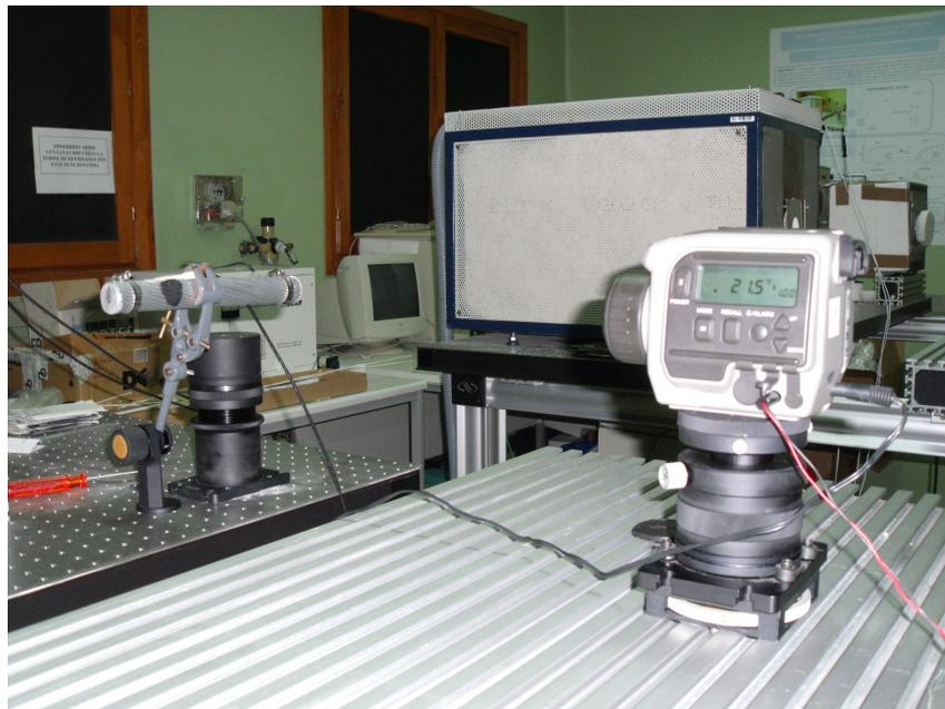
FIGURA 3.22: Medida de la temperatura de radiación de las muestras con el termómetro C300
