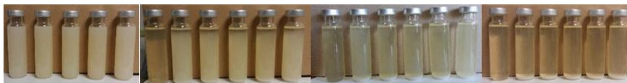
**Figura 78: Muestras surfactadas con  $\text{TiO}_2$  y su evolución tras 1, 3, y 6 días.**
