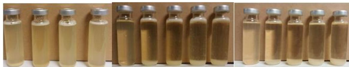
**Figura 79: Muestras surfactadas con  $\text{ZnO}$  y su evolución tras 1 y 5 días.**
