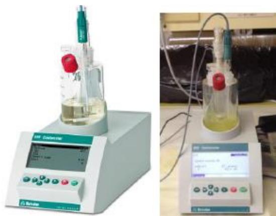
**Figura 33: Culombímetro Metrohm 899 [84].**
