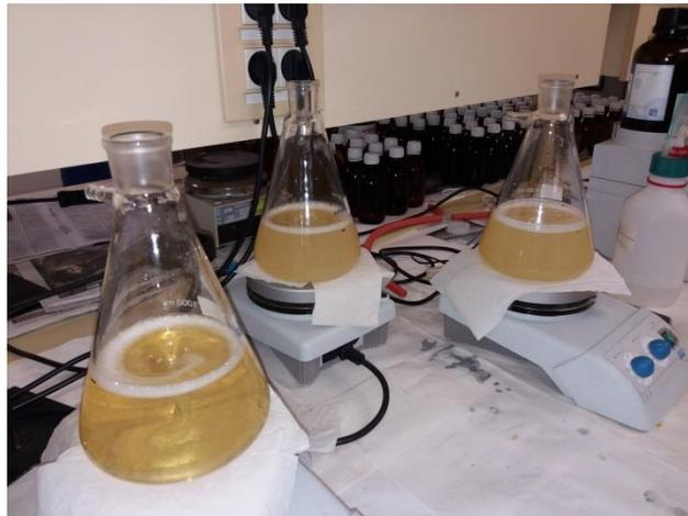
**Figura 24: Mezclas de nanofluidos sometidas a agitación magnética.**
