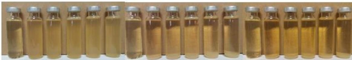
**Figura 81: Segundo intento de muestras surfactadas de  $\text{ZnO}$ , tras 1 y 5 días.**
