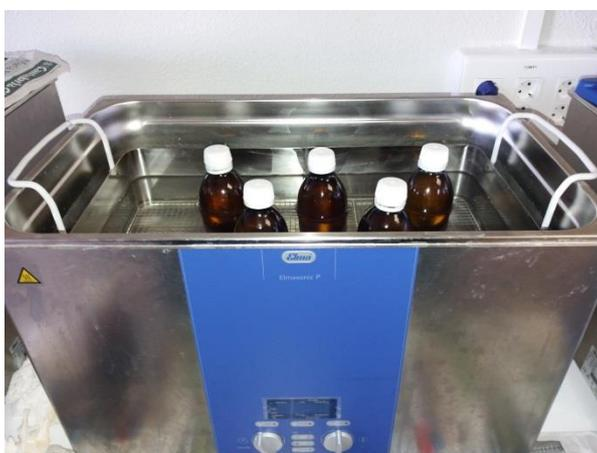
**Figura 27: Muestras de nanofluidos sometidas a agitación por ultrasonidos.**
