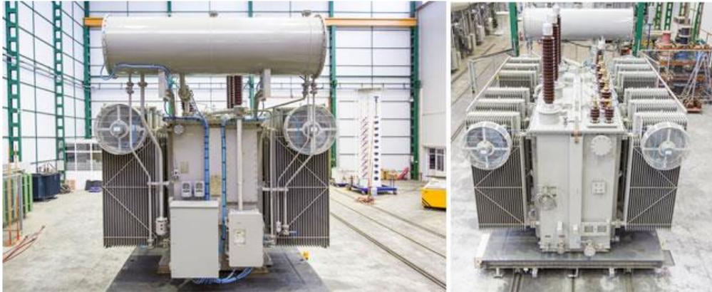
**Figura 10: Sistema de refrigeración líquido con ventiladores y radiadores [19].**
