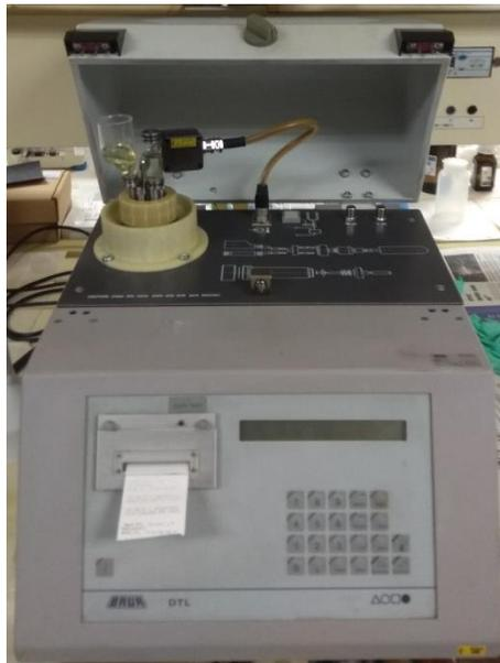
**Figura 28: Ensayador de aceites aislantes BAUR DTL 2a.**
