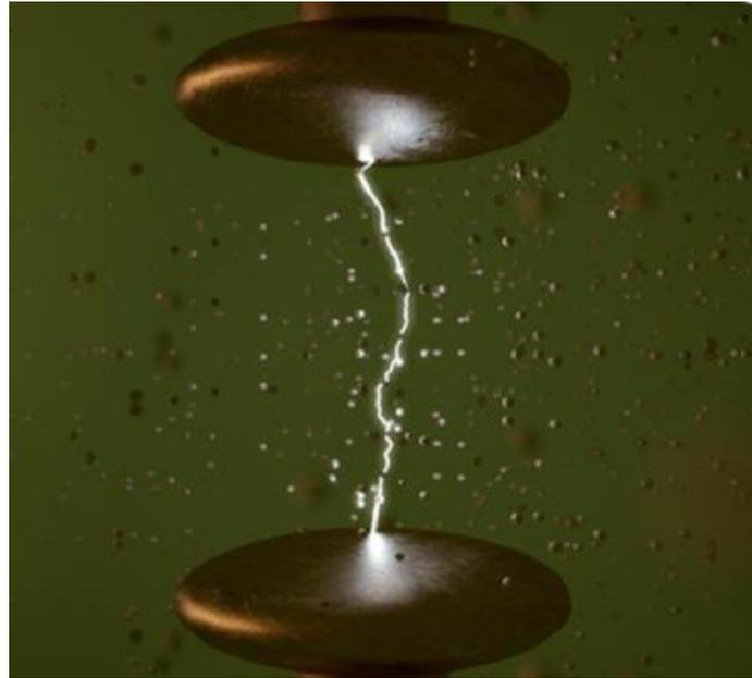
**Figura 15: Formación del arco eléctrico a través del material aislante [30].**
