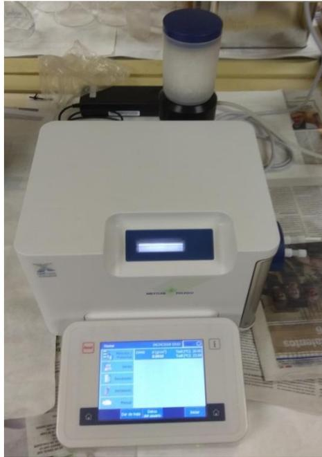
**Figura 35: Densímetro Mettler Toledo.**
