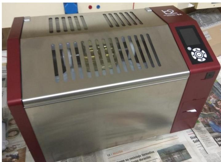
Figura 30: Ensayador de aceites aislantes b2 bA 100.
