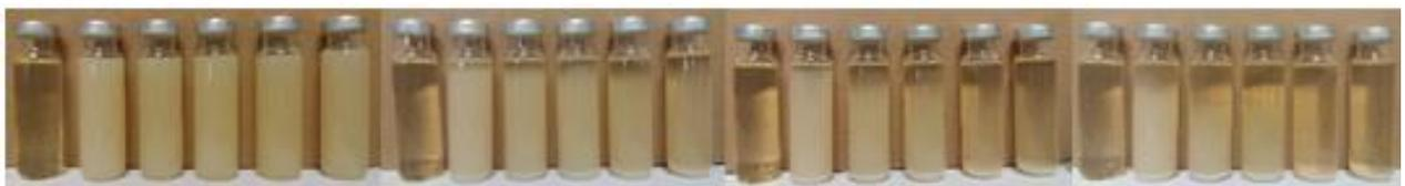
**Figura 80: Segundo intento de muestras surfactadas de  $\text{TiO}_2$ , tras 1, 5, y 9 días.**
