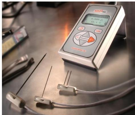
Figura 40: Medidor de conductividad KD2 PRO [89].
