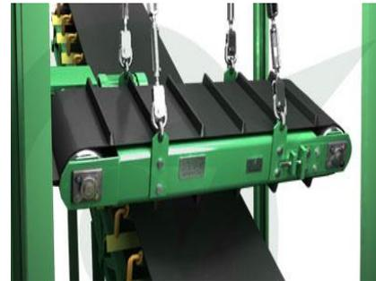
Figura 3.7: Imán sobre cinta transportadora.
