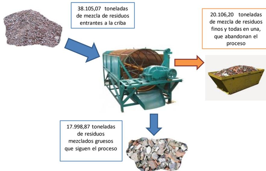
Figura 4.3: Balance de masas sobre la criba rotatoria. Fuente: Elaboración propia
