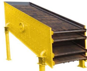
Figura 3.5: Criba vibratoria. Fuente: Jiangxi Shicheng
