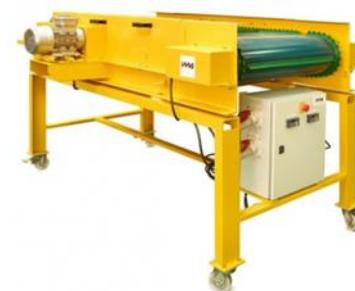
Figura 3.8: Separador por corrientes de Foucault. Fuente: Bunting magnetics Europe
