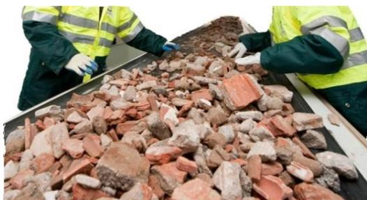
Figura 4.5: Representación de la Extracción manual en la cabina de clasificado. Fuente: Elaboración propia
