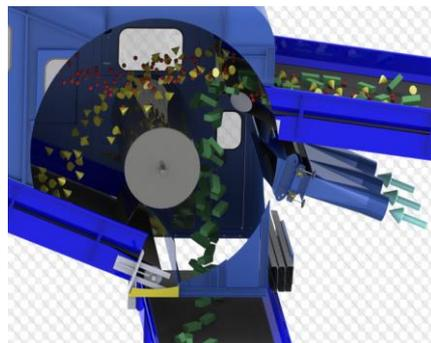
Figura 3.9: Máquina de tamizado por flujo de aire.
