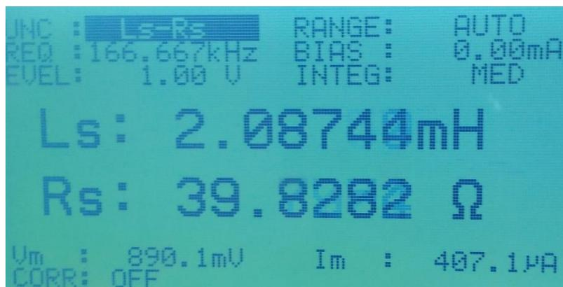
Figura 80. Inductancia y Resistencia equivalente en serie
