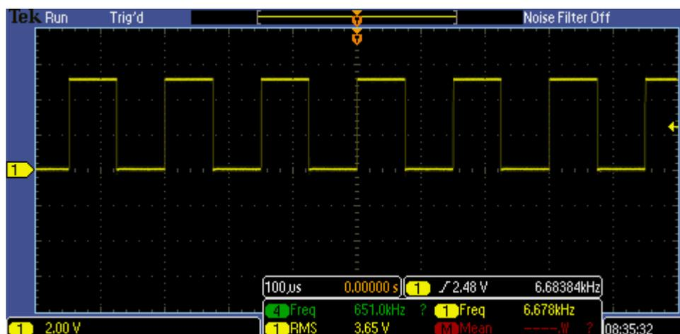
Se comprueba que proporciona una frecuencia de 6.678kHz y un ciclo de trabajo del 50%, estos parámetros son válidos para la electroerosión.
