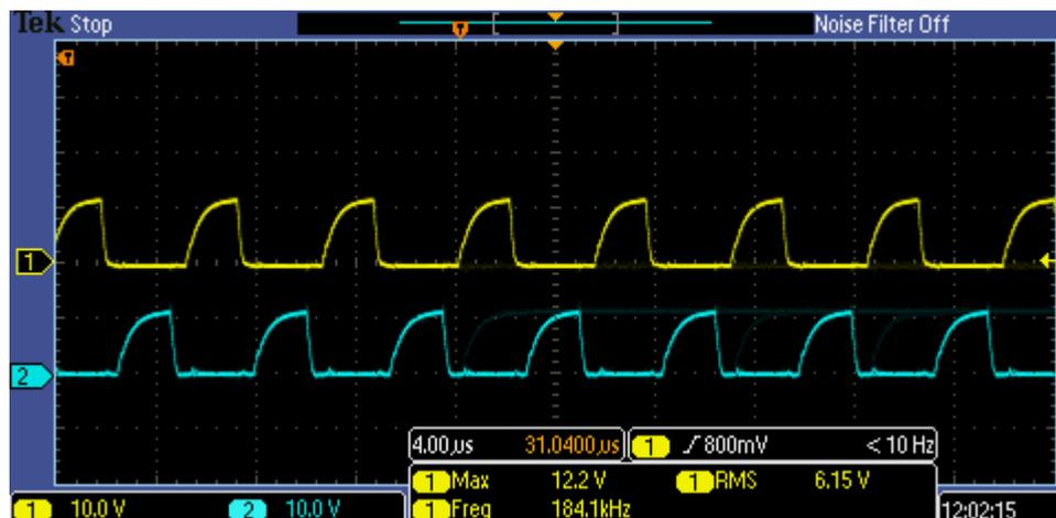
Figura 67. Señal puerta-fuente de los dos transistores,  $V_{GS1}$ ,  $V_{GS2}$ .
