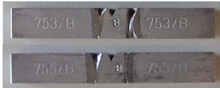
**Figura 4.22** Instantánea de la apariencia final de las probetas PCCv reconstruidas por ASW
